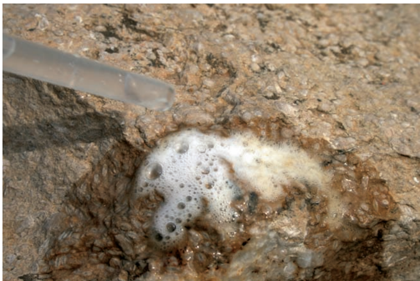
Figura 3. Reacció senzilla per identificar la presència de carbonat de calci en una roca calcària. Els experiments a peu d'itinerari són especialment efectius i agraïts, ja que copsen l'atenció dels alumnes i els recorden bé.
