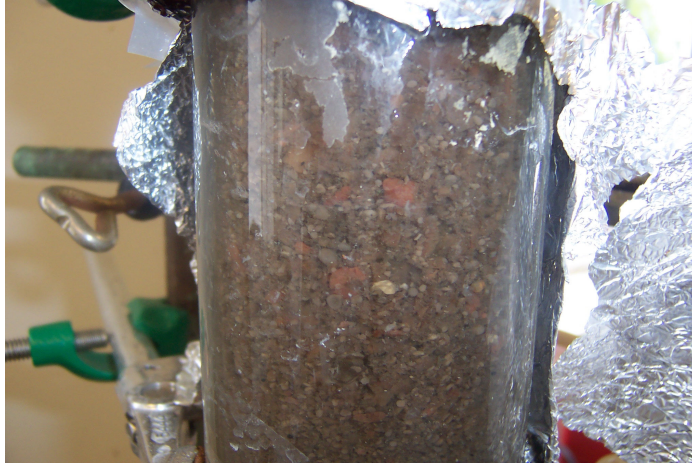
Foto 1.2. Reactor UASB amb el color vermell del fang
