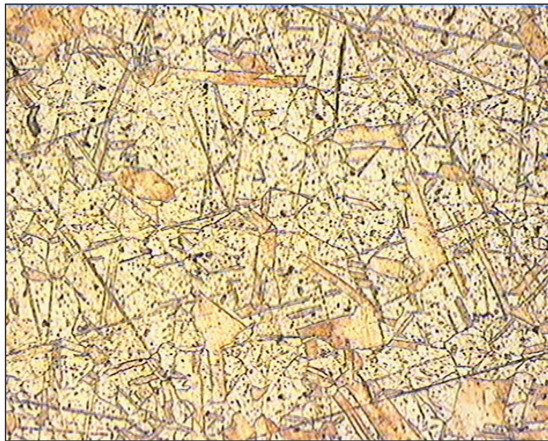
Micrografia 1. Coure deformat en fred a tracció. S'observa el desordre i l'allargament dels grans. (x20, 0,375 mm reals de base)
