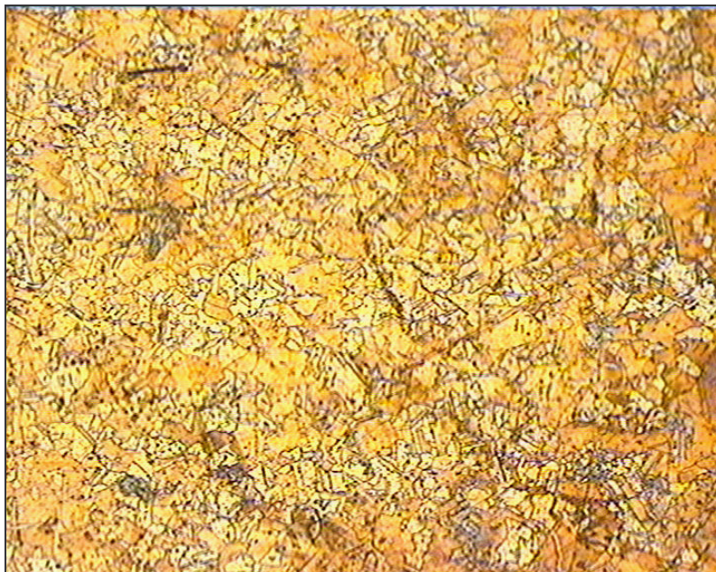
Micrografia 3. Coure deformat en fred a tracció. Inici de la recristal·lització. Grans petits i ordenats. (x20, 0,375 mm reals de base)
