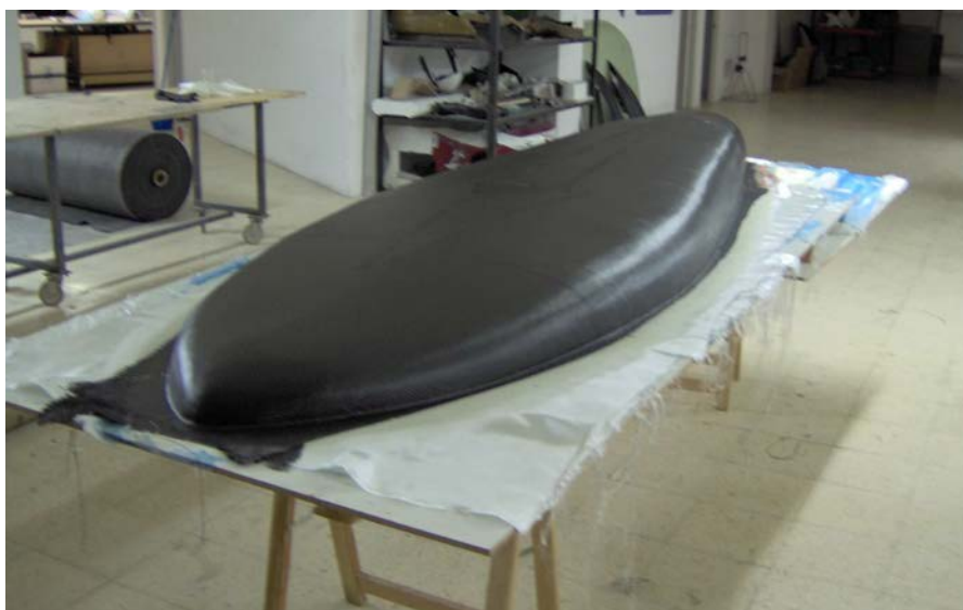
Figura 20 – Carrosseria inferior laminada.
