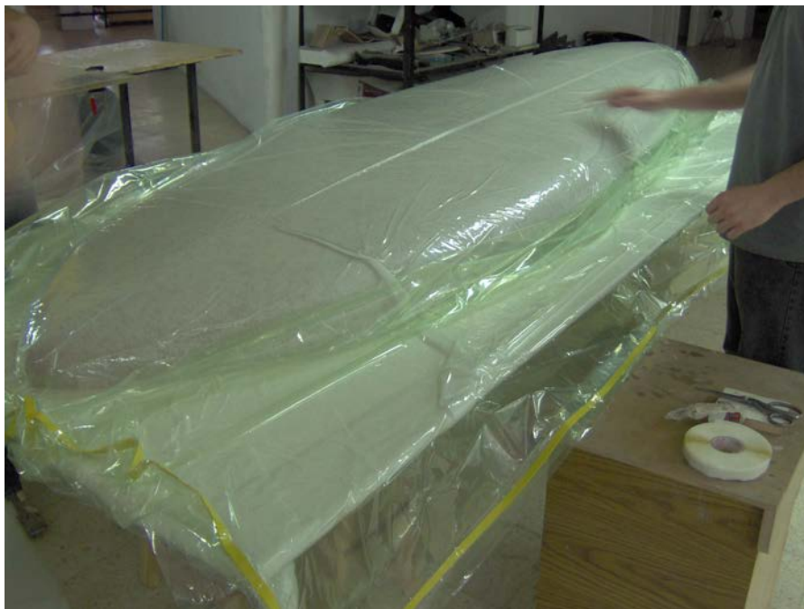
Figura 6 – Realització del buit al model inferior.
