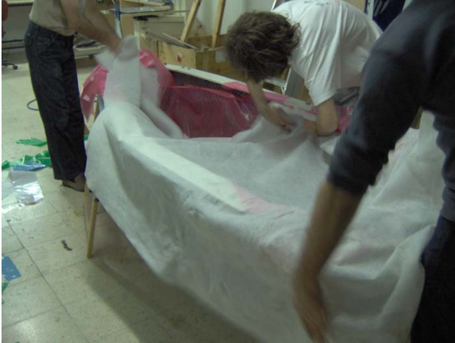
Figura 18 – Col·locació del film sagnador i la manta d'absorció.
