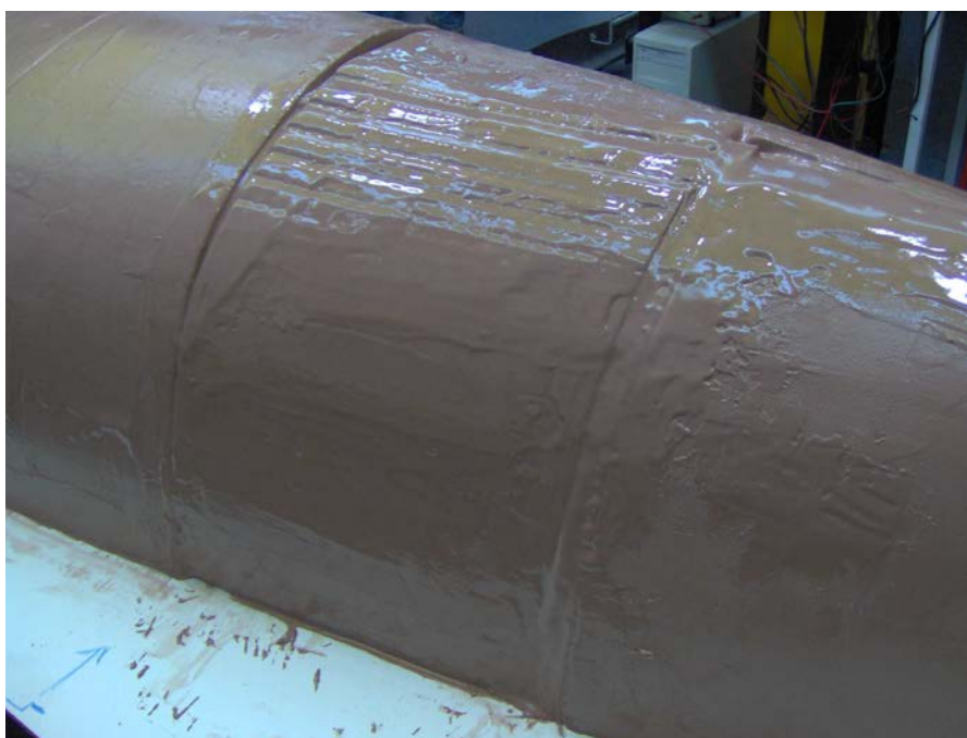
Figura 4 – Defectes de la mecanització.
