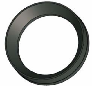
Fig.29 Representació del seient de la culata
