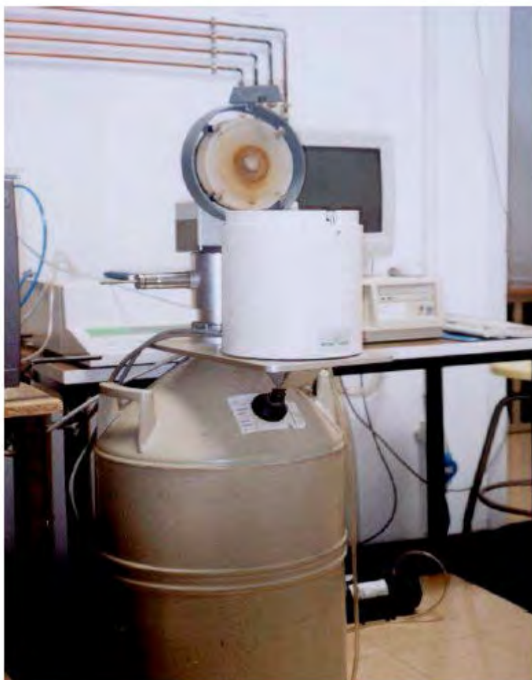
Figura 3.6. Fotografía del DSC30 de la casa Mettler.
