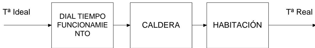
Figura 33. Ejemplo de Sistema de lazo abierto
