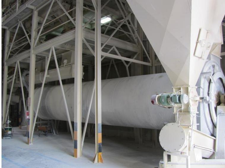
Figura 61. Cuerpo de un horno de combustión rotativo
