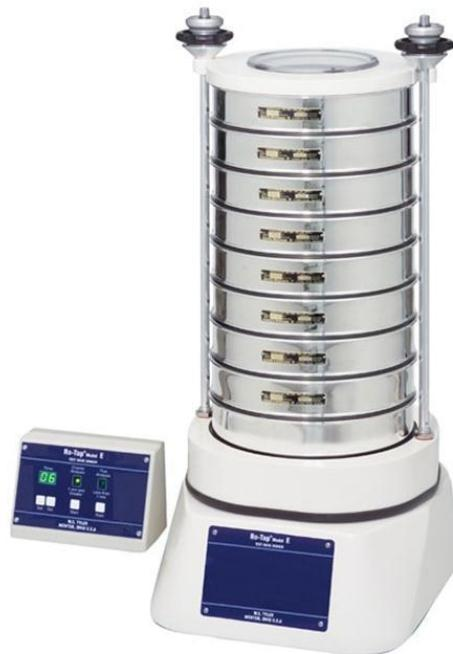
Figura 94. Tamizadora electromagnética modelo TYLER ROTAP SS-36
