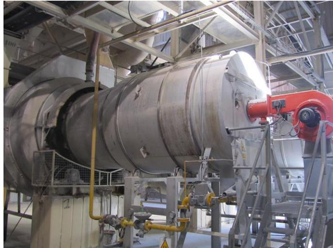
Figura 87. Vista de la cámara de combustión de un horno de anhidrita
