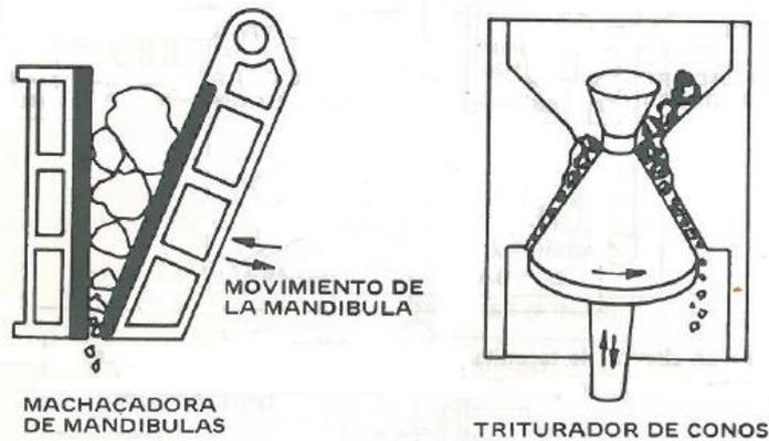
Fig. 1-6. Machacadoras de mandíbulas y cono.
