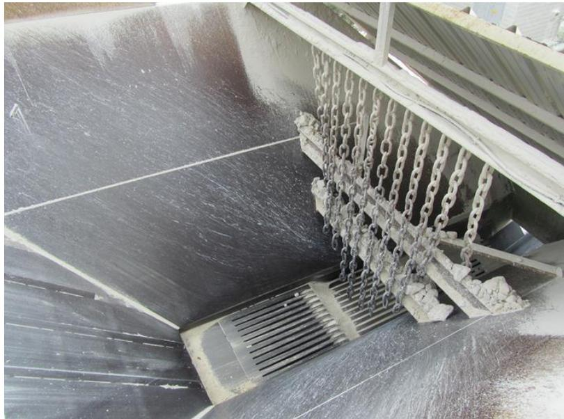
Figura 83. Vista de la tolva de material de entrada al proceso
