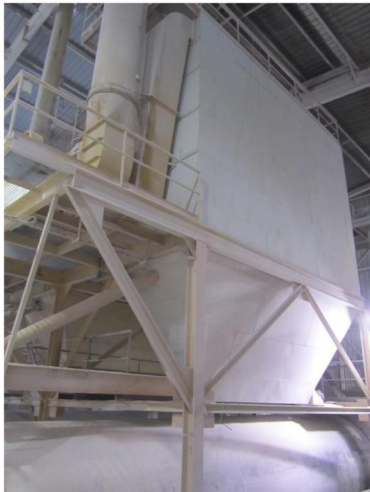
Figura 64. Filtro de mangas de un horno de calcinación
