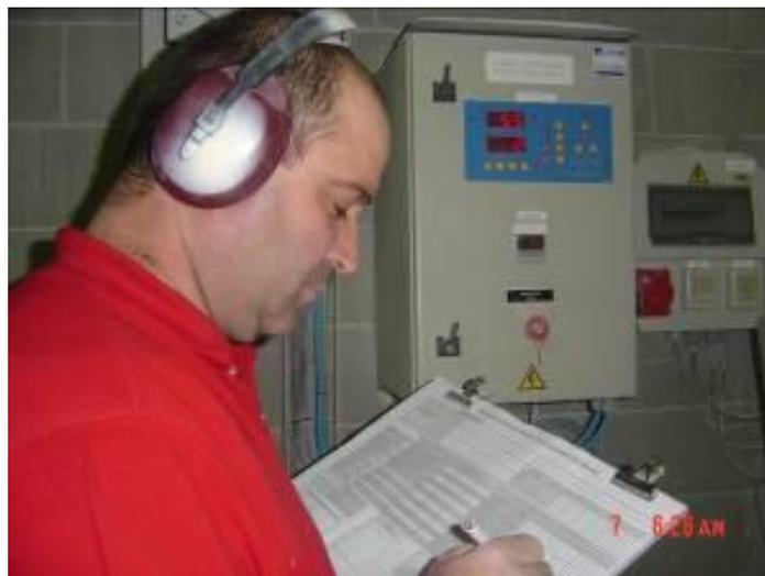
Figura 92. Operario realizando registros de control de calidad en horno de anhídrita
