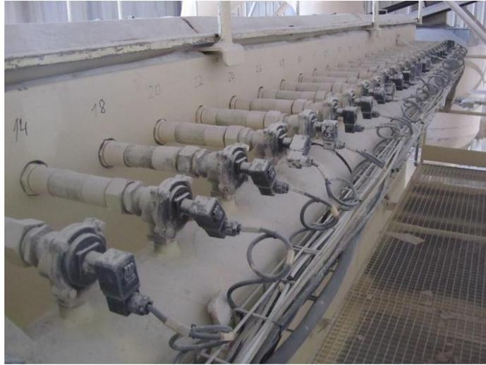
Figura 63. Vista válvulas de descarga de mangas de un filtro
