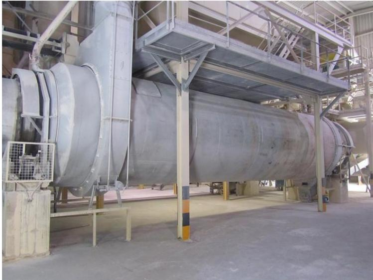
Figura 86. Vista general de un horno de anhidrita
