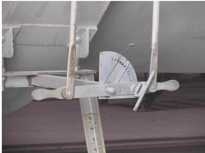
Figura 66. Regulador de la aspiración en un horno de anhidrita
