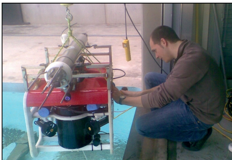
Fig. 4.8. Col·locació de les espumes (color blau) per equilibrar la flotabilitat de l'Ictineu a la piscina del grup VICOROB.
