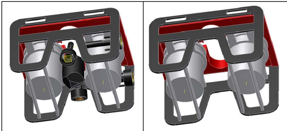
Fig. B.5. Vista isomètrica inferior amb cos central i propulsors (esquerra) i sense (dreta).
