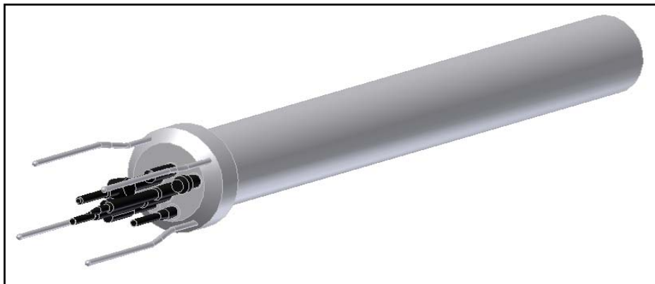
Fig. B.7. Vista isomètrica del perfilador modelat amb Inventor.
