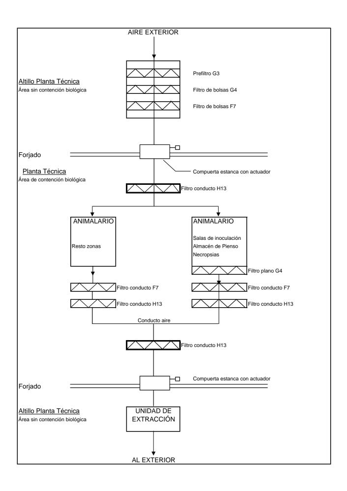
Por medio de este esquema se pretende dar una rápida visión de cómo se han previsto los escalones de filtración de manera general. Más adelante se entrará en el detalle de la filtración del aire en cada sala.
