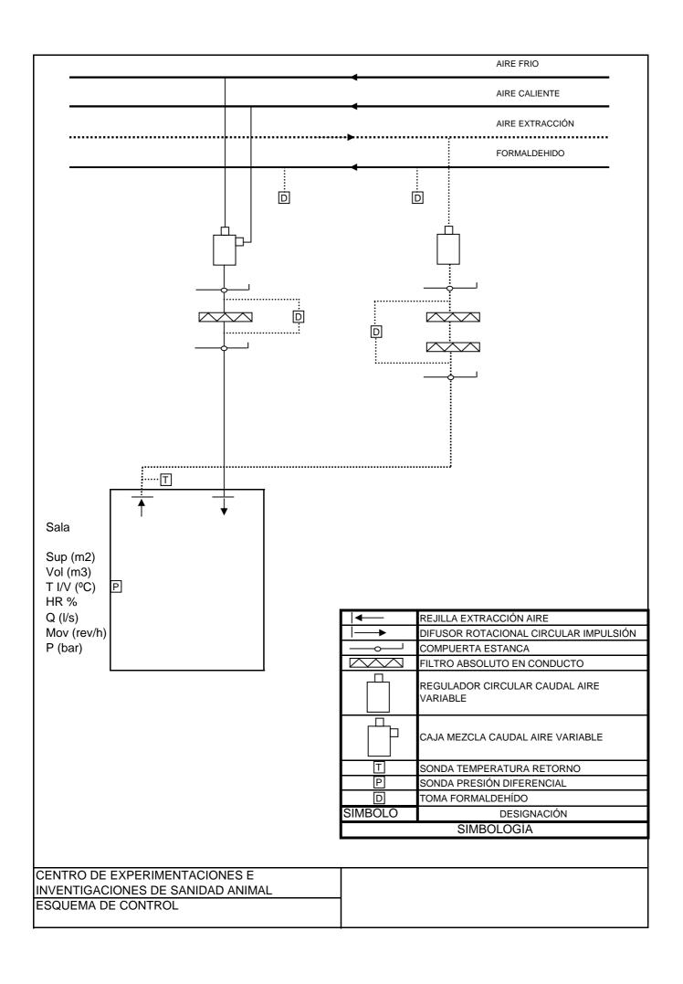
Mediante el Esquema de Control se pretende dar una indicación visual rápida del funcionamiento de la instalación y poder conocer los parámetros requeridos en cada sala.
