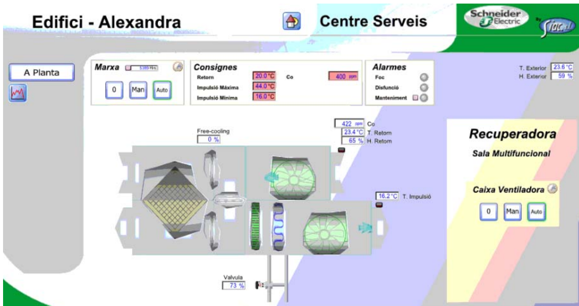
Figura 24. Control i monitorització del climatitzador del Centre de Serveis
