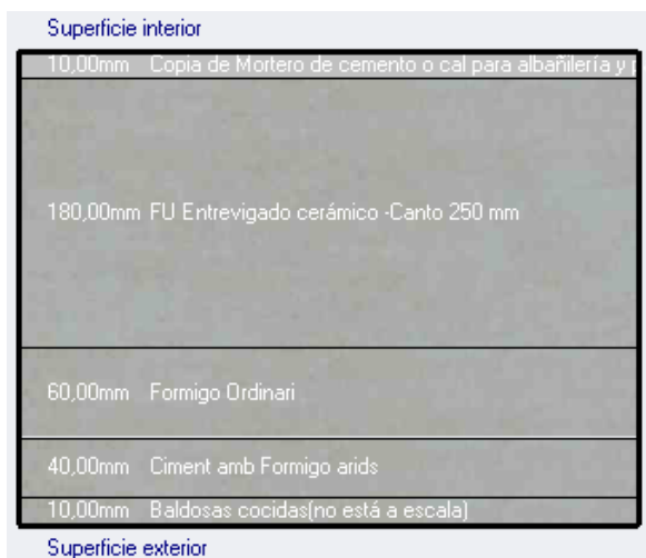
Figura 34. Composició del forjat intern
