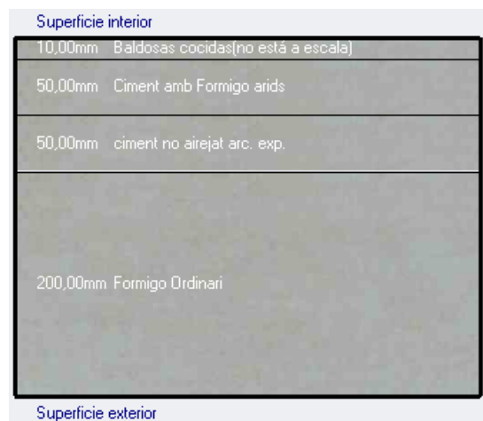
Figura 35. Composició del forjat en contacte amb el terreny
