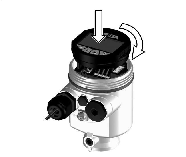
Fig. 26: Poner módulo de visualización y configuración
