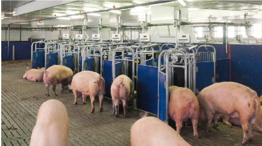
Figura 17. Sistema d'alimentació per identificació en granja de truges.
