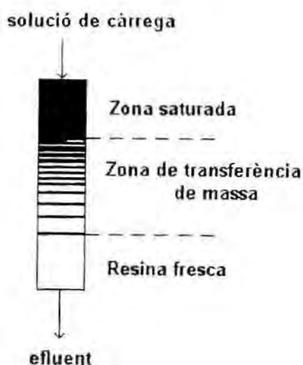
Figura 1.4. Esquema del perfil de concentracions d'un llit fix de resina.
