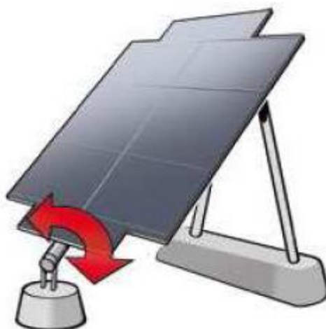
Figura 11. Moviment rotació seguidor
