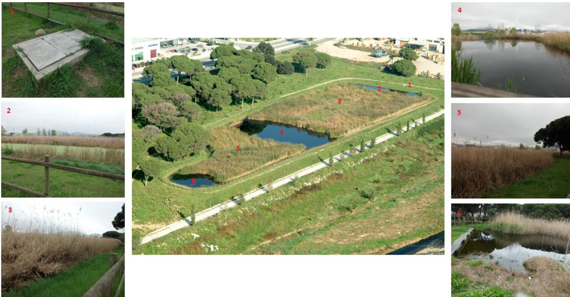
Figura 15. Plànol del SAC de Can Cabanyes: 1) arqueta entrada, 2) capçalera aiguamoll, 3) primera zona somera i illa, 4) zona profunda central, 5) segona zona somera, 6) sortida aigua aiguamoll. Font: Consorci per la defensa de la conca del riu Besòs. Imatges d'elaboració pròpia.
