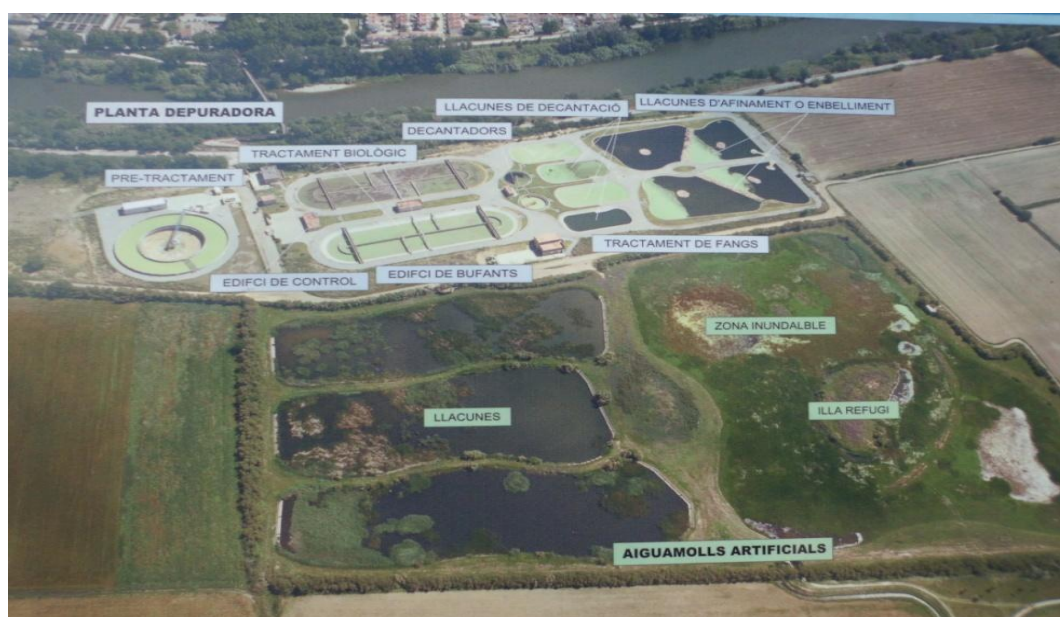
Figura 11. Esquema de l'EDAR i el SAC d'Empuriabrava. Font: SAC Empuriabrava.
