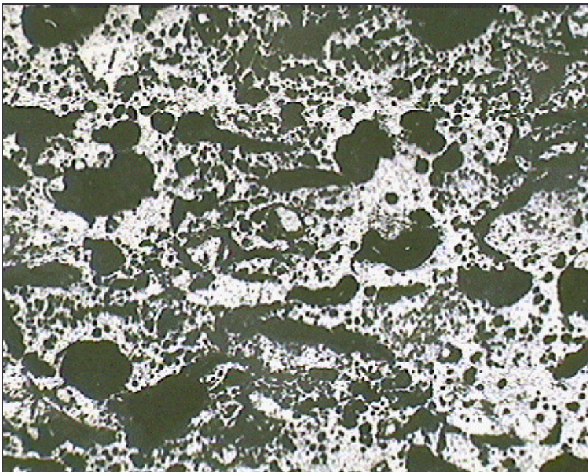
Micrografia 13. Vista general d'una rajola de gres 5 % vidre d'ampolla d'entre 125 i 300 µm cuita al forn de laboratori a 1320 °C. Absorció d'aigua: 5,88 %. (x5, 1,5 mm reals de base)
