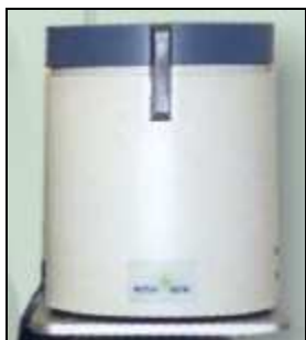
Figura 3.9 Calorímetre diferencial d'escombrat DSC30.
