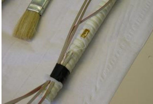
Figura 11: Col·locació de les galgues a les barres de reforç
