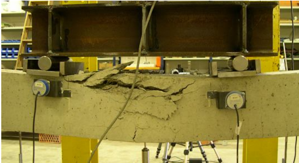
Figura 3: Col·locació dels inclinòmetres
