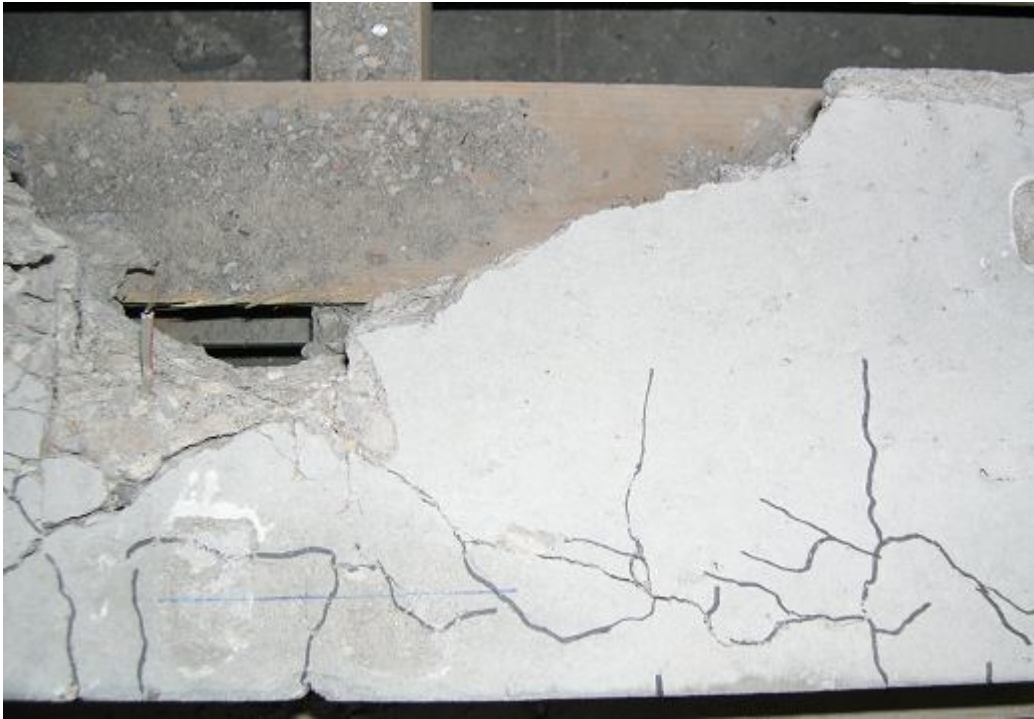
Figura 7: Resultat de l'assaig i fissures
