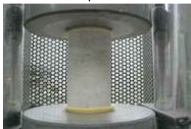
Figura 2: Assaig a compressió
