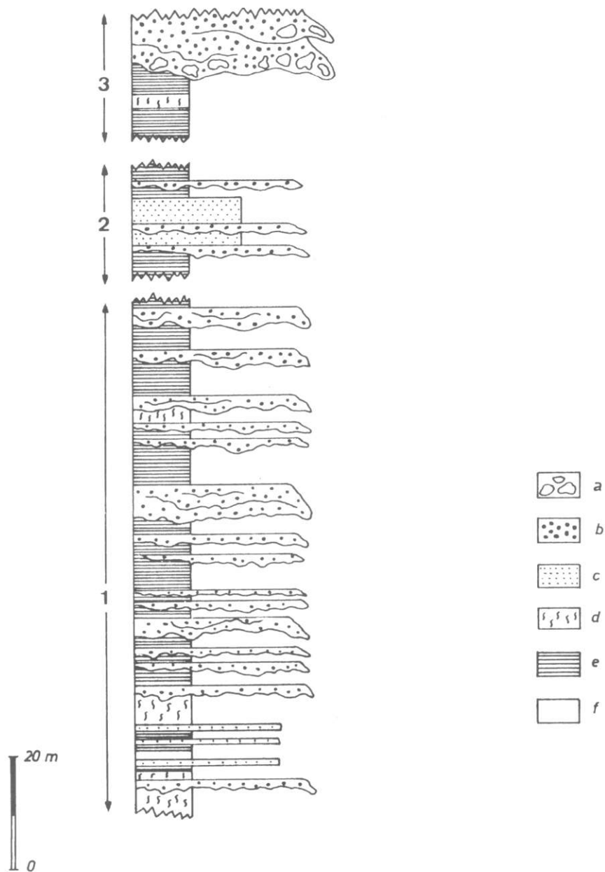
Fig.5. Sèrie sintètica del Neogen de les vores del massís deies Gavarres. Llegenda: 1: Miocè (Vallesià), 2: Miocè (Turollà). 3: Pliocè superior. Materials, a: Grans blocs, b: Graves, c: Sorres, d: Paleosòls, e: Argiles, f: Argiles blaves.
