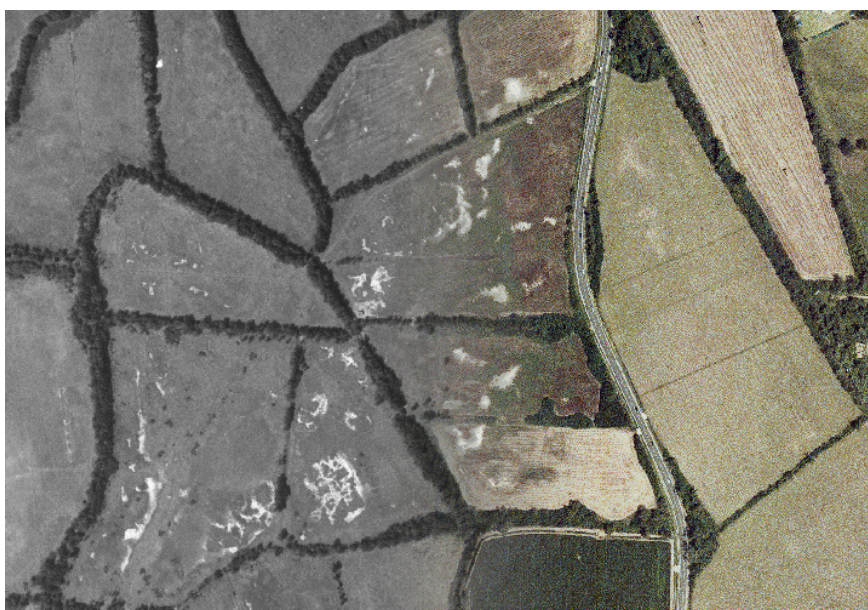
Figura 4.4. Fotocomposició mostrant la bona superposició obtinguda entre les imatges de 1970 (a l'esquerra) i les ortofotografies de 2001 (a la dreta). Font: elaboració pròpia a partir del tractament de fotografies aèries corresponents a l'any 1970 i ortofotografies de l'any 2001 facilitades per l'Institut Cartogràfic de Catalunya.
