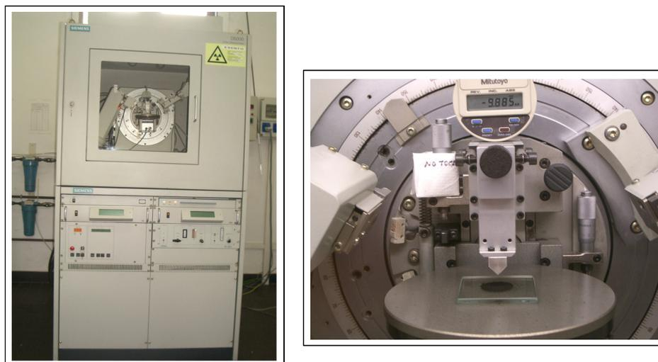
**Figura 3-16.** Fotografía del dispositivo de DRX Siemens 5000 empleado.
