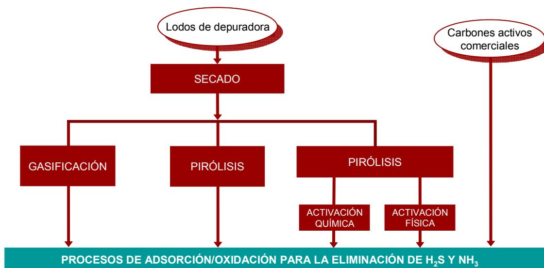
**Figura 3-4.** Esquema del proceso de obtención y aplicación de los adsorbentes/ catalizadores derivados de lodos y carbones comerciales empleados.
