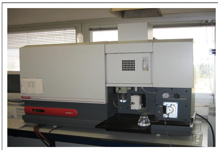
Figura 3-18. Fotografía del dispositivo de ICP-AES empleado en el estudio.
