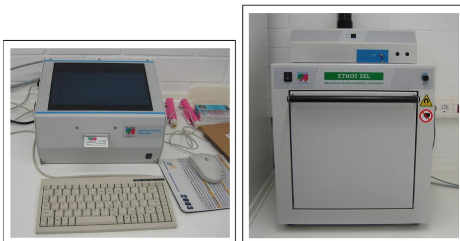
**Figura 3-19.** Fotografía del digestor de microondas utilizado en la digestión ácida de las muestras.
