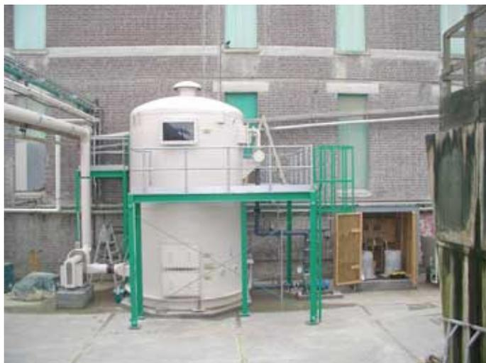
**Figura 2-14.** Fotografía de un bioabsorbedor [159].
