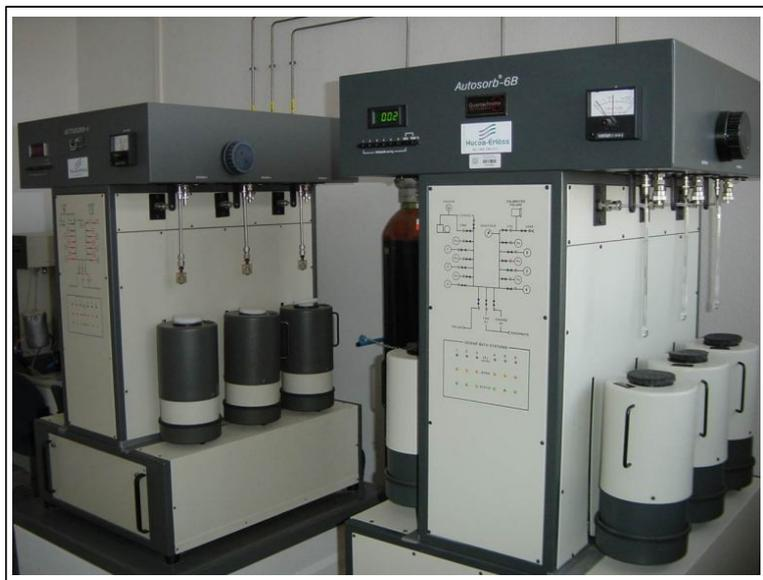
Figura 3-15. Fotografía del equipo Autosorb-6 empleado para la obtención de las isotermas de adsorción.
