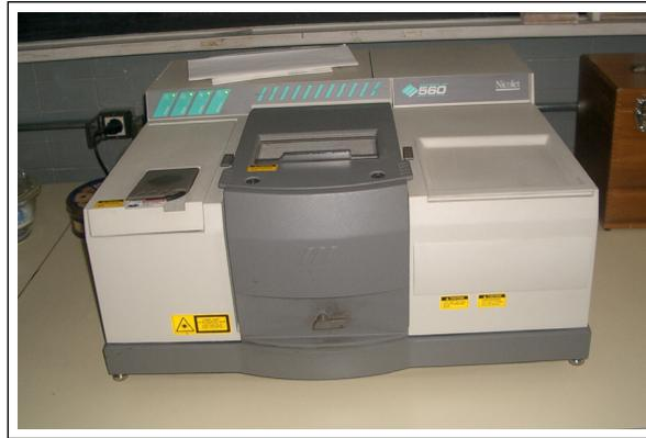
**Figura 3-20.** Fotografía del FT-IR utilizado en los experimentos.
