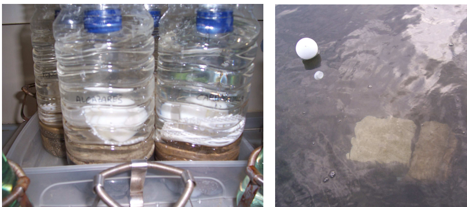
Figura 3.6. Exposició dels dispositius DGT a aigua i sediments del mar Menor. A l'esquerra, experiments al laboratori, i a la dreta, experiments de camp.
