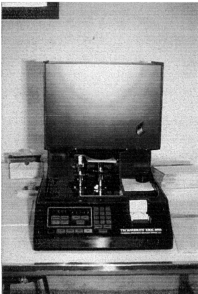
Figura 4-13: Espectrofotòmetre Technibrite Micro TB-1C amb l'opció ERIC 950.
