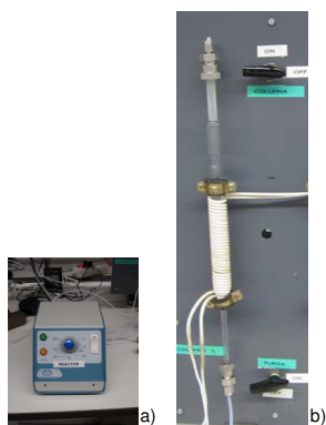
Figura 3.15. Detalle del regulador de temperatura utilizado (a), y de la columna de vidrio envuelta con la manta calefactora (b).
