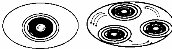
Figura A2.1.18: Àrea d'acció de l'agitador convencional i del mesclador planetari (Tremblay, 1998)
