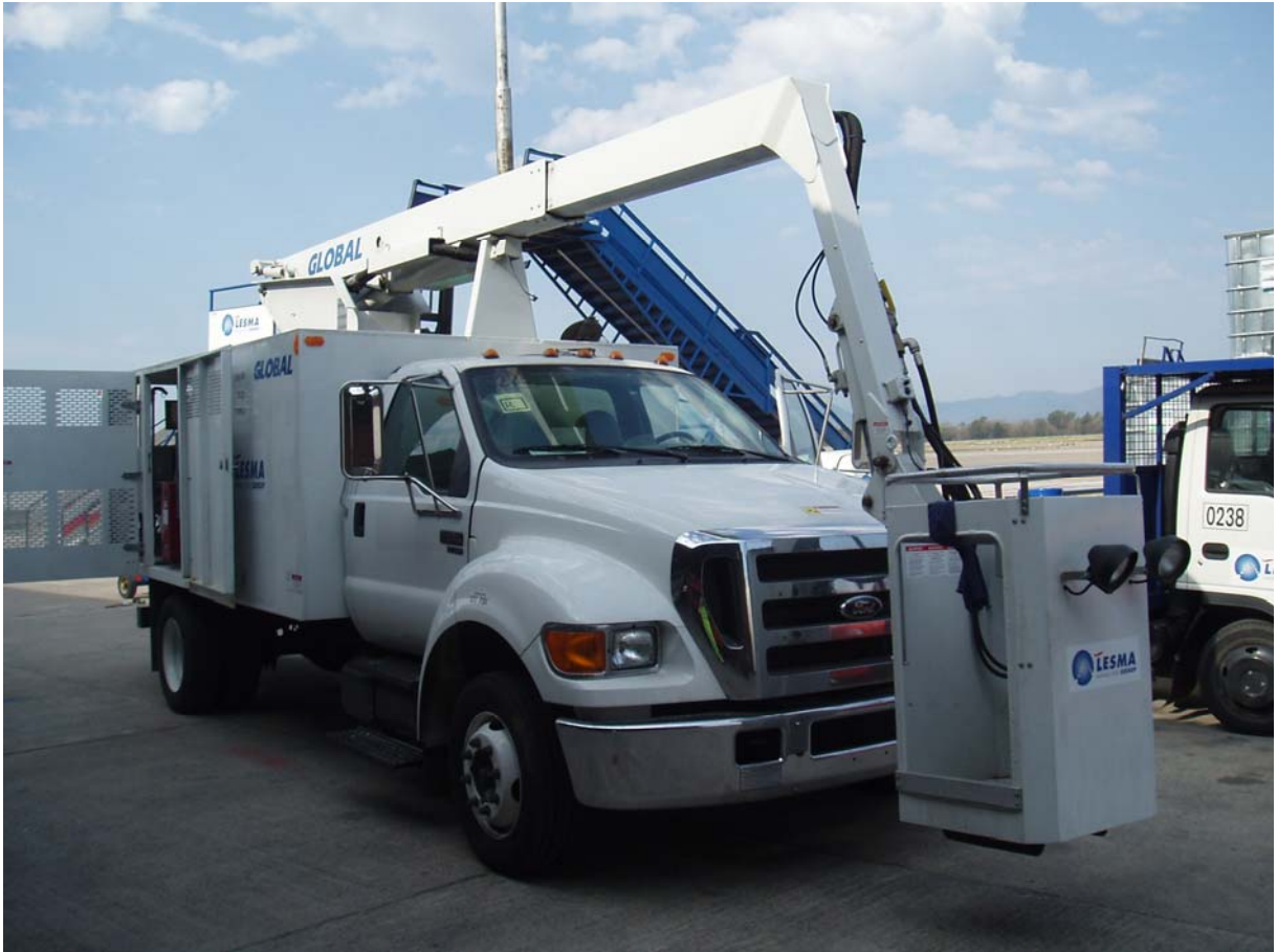
Figura 19. Unitat mòbil aplicadora de la mescla glicol i aigua.
