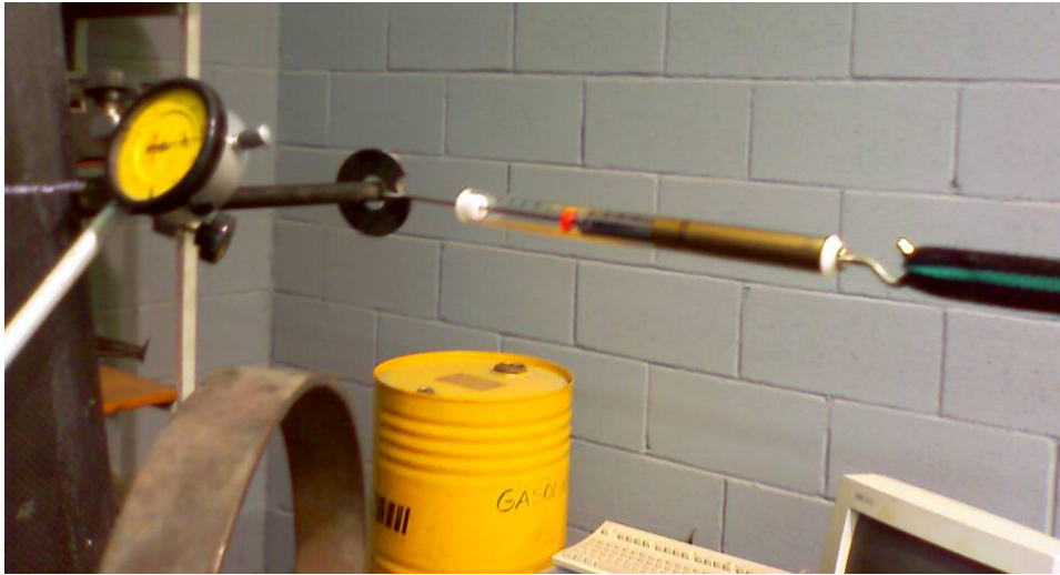
Fig.26 Detall del rellotge comparador i el dinamòmetre per controlar el parell aplicat
