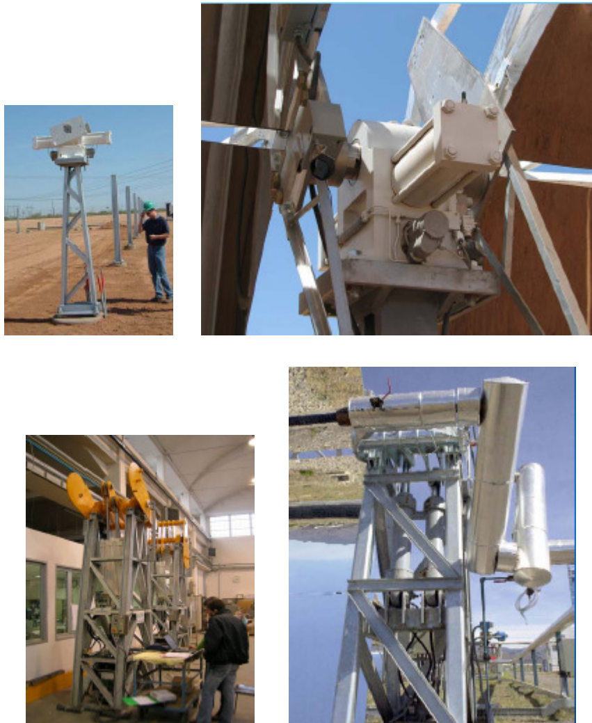
Imatge C-6: Imatges de diferents models d'accionaments de seguiment hidràulics.
