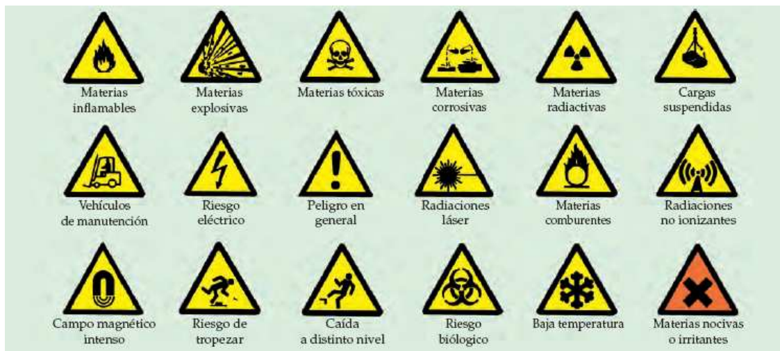
Figura D.1. Senyals obligatòries d'avertiments de perill en les obres (Font [15]).
