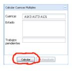
4. Mientras se ejecuta el proceso, un gif animado aparece y un campo de estado da información sobre las diferentes fases del cálculo. El campo de "Trabajos Pendientes" indica cuantos procesos están delante en la cola de trabajo. Cuando termina la primera parte del proceso, aparece automáticamente una nueva geometría en el cliente Web que combina las áreas seleccionadas.
