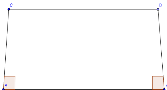
Figura 2. Si els dos angles, A i B , són rectes i els costats corresponents són iguals aleshores C i D són angles iguals.
