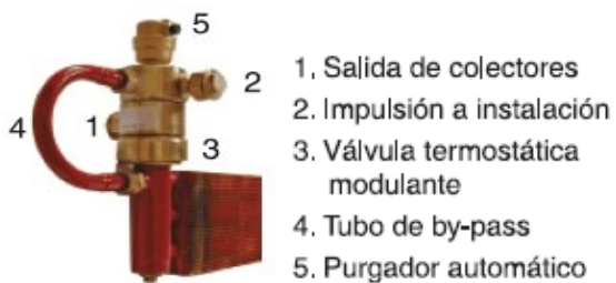
Il·lustració 14. Elements del dissipador.
