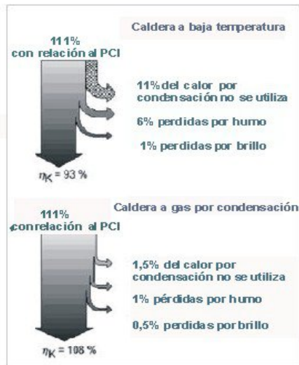
Il·lustració 8. Diferències entre els tipus de calderes.
