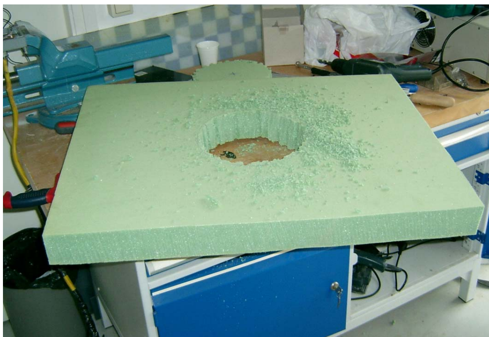
Figura 30 Construcció del flotador
