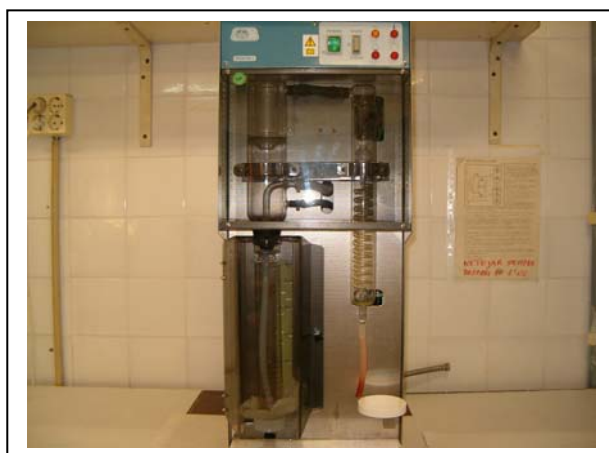
Fotografia 2: Digestors Kjeldhal utilitzat per a mesurar el nitrogen total de les mostres (fotografia: Miquel Serrat)
