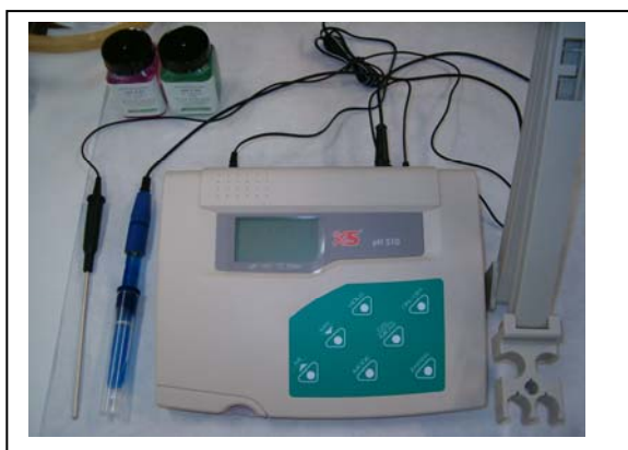
Fotografia 1: pHmetre CybersCan 510 utilitzat en les mesures de pH de les mostres de sòl (fotografia: Miquel Serrat).
