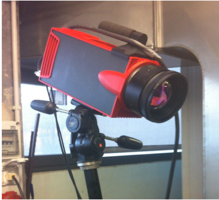
Figura 2.12 Càmera termogràfica IRBIS ImageIR 3300
