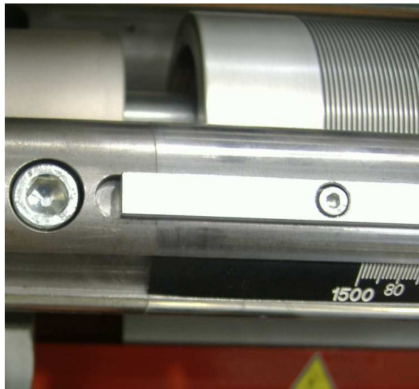
Figura A.1: Detall de l'extrem del regle per posicionar les gilletes.
