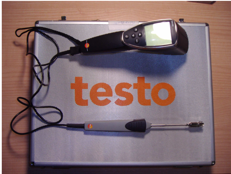
Figura B.1: Sonda digital TESTO 845 de mesura de temperatures.
