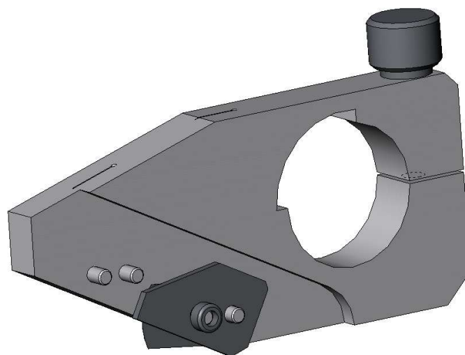
Figura 3.14: Muntatge suport magnètic gilette + gilette + placa aplaca gilette + pom fixació gilette + pom fixació portagilette.
