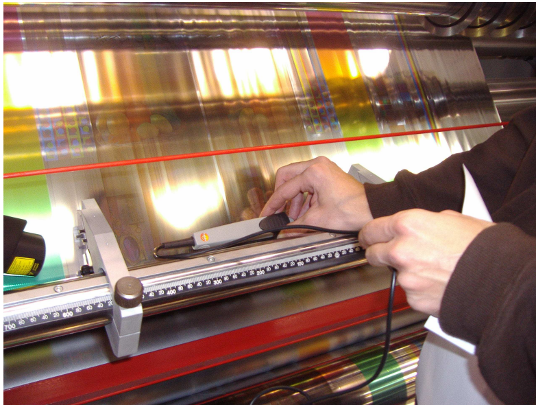
Figura B.6: Assaig experimental de mesura de temperatures del conjunt de tall gillette. Detall de les mesures amb la sonda de contacte.
