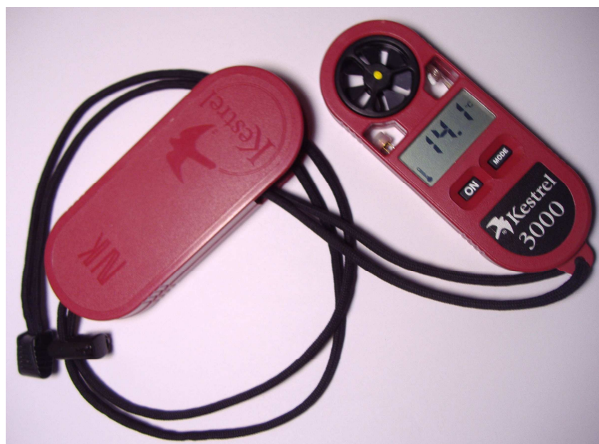
Figura 3.17: Sonda digital multifunció (temperatura, humitat, velocitat vent)
