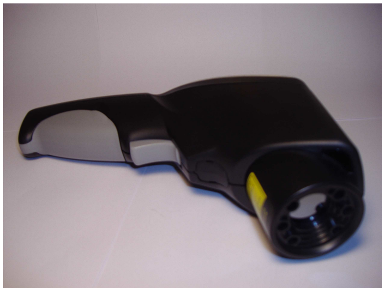
Figura B.2: Detall pistola làser TESTO 845.
