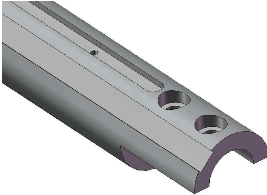
Figura 3.2: Eix portagillettes (detall xaveter i allotjament regle).
