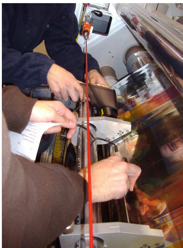
Figura B.4: Assaig experimental de mesura de temperatures del conjunt de tall gillette.
