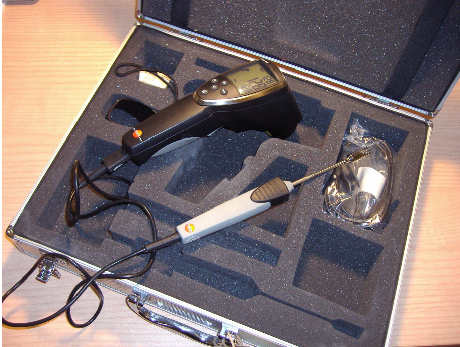
Figura 3.18: Sondes digitals per mesurar temperatures (part superior: làser; part inferior: de contacte)
