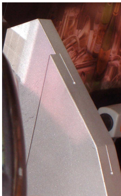
Figura A.3: Suport magnètic gillette; detall de les marques pel posionat amb làser.
