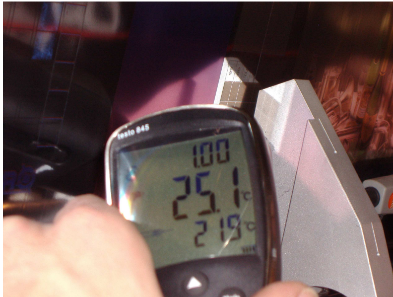
Figura B.7: Assaig experimental de mesura de temperatures del conjunt de tall gillette. Detall de la pantalla digital (25,1 °C pistola làser; 21,9°C sonda de contacte).
