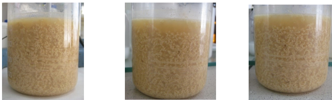
Imatge 0.8: Procés de sedimentació del flocculant PeQu-PL131.2. El temps de sedimentació de cada imatge és d'esquerra a dreta: temps inicial, 15 minuts i una hora.
