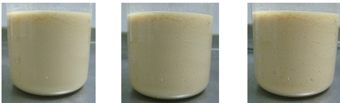
Imatge 0.11: Procés de sedimentació del floculant ZETAG 9016. El temps de sedimentació de cada imatge és d'esquerra a dreta: temps inicial, 15 minuts i una hora.
