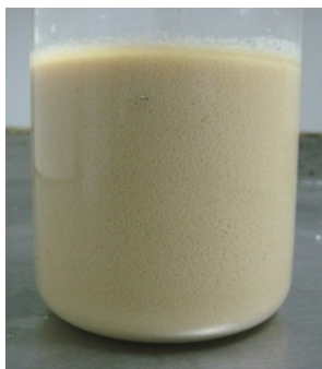
Imatge 0.5: Procés de sedimentació del floculant NF 920 SH. El temps de sedimentació de cada imatge és d'esquerra a dreta: temps inicial, 15 minuts i una hora.
