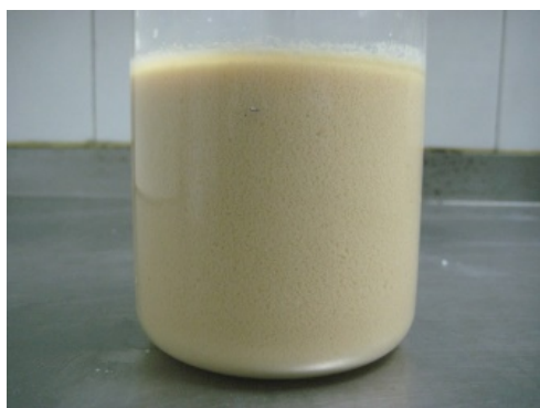
Imatge 3.9: Temps inicial de la sedimentació amb el floculant NF 920 SH
