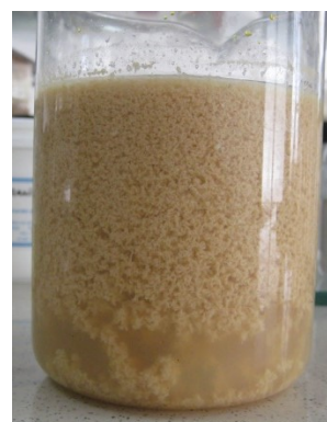
Imatge 0.6 Procés de sedimentació del floculant PeQu-133. El temps de sedimentació de cada imatge és d'esquerra a dreta: temps inicial, 15 minuts i una hora.
