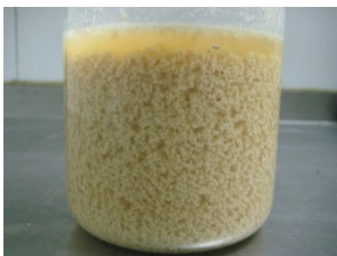
Imatge 3.5: Temps inicial de la sedimentació amb el floculant EM 840 MEB
