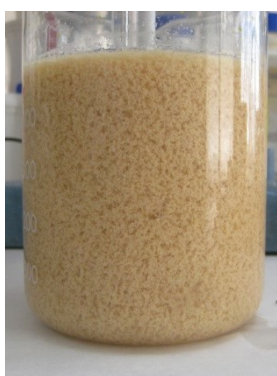
Imatge 0.6 Procés de sedimentació del floculant PeQu-133. El temps de sedimentació de cada imatge és d'esquerra a dreta: temps inicial, 15 minuts i una hora.
