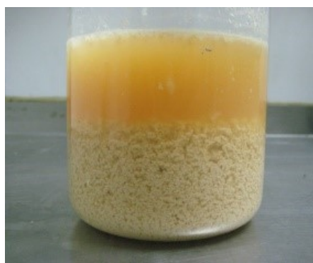
Imatge 3.4: Temps final de la sedimentació amb el floculant EM 840 MEB
