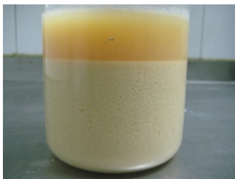
Imatge 3.8: Temps final de la sedimentació amb el floculant NF 920 SH
