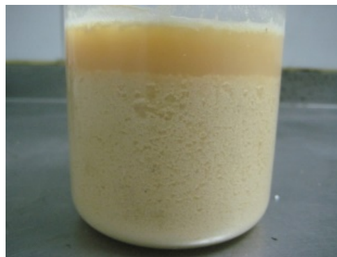
Imatge 3.6: Temps final de la sedimentació amb el floculant AF 934 SH
