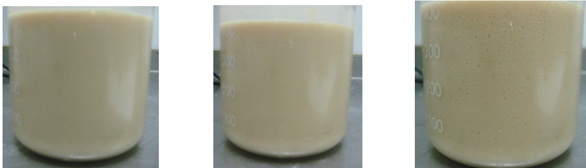
Imatge 0.10: Procés de sedimentació del floculant ZETAG 8818. El temps de sedimentació de cada imatge és d'esquerra a dreta: temps inicial, 15 minuts i una hora.
