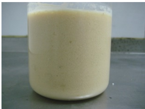
Imatge 3.7: Temps inicial de la sedimentació amb el floculant AF 934 SH
