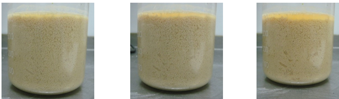
Imatge 0.2: Procés de sedimentació del floculant EM 640 MEB. El temps de sedimentació de cada imatge és d'esquerra a dreta: temps inicial, 15 minuts i una hora.
