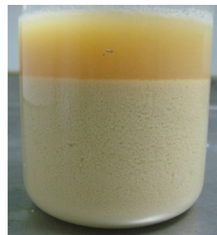
Imatge 0.5: Procés de sedimentació del floculant NF 920 SH. El temps de sedimentació de cada imatge és d'esquerra a dreta: temps inicial, 15 minuts i una hora.
