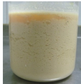
Imatge 0.4: Procés de sedimentació del floculant MAGNAFLOC CT20. El temps de sedimentació de cada imatge és d'esquerra a dreta: temps inicial, 15 minuts i una hora.
