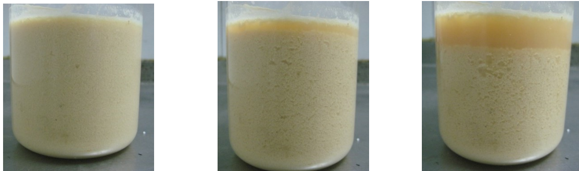
Imatge 0.1: Procés de sedimentació del floculant AF 934 SH. El temps de sedimentació de cada imatge és d'esquerra a dreta: temps inicial, 15 minuts i una hora.
