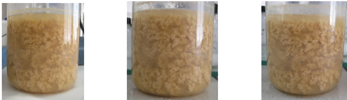
Imatge 0.7: Procés de sedimentació del flocculant PeQu-PL131. El temps de sedimentació de cada imatge és d'esquerra a dreta: temps inicial, 15 minuts i una hora.
