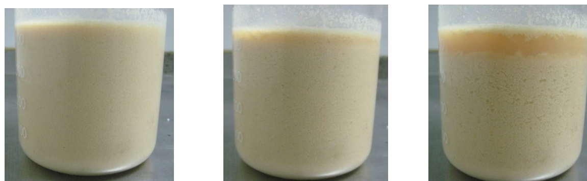
Imatge 0.9: Procés de sedimentació del flocculant ZETAG 4145. El temps de sedimentació de cada imatge és d'esquerra a dreta: temps inicial, 15 minuts i una hora.
