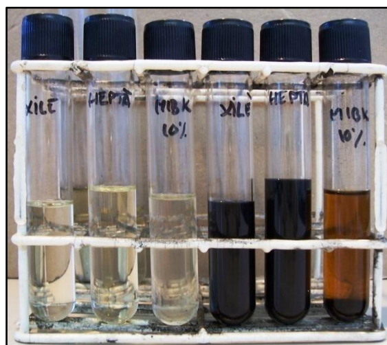
Figura 5. 2: Dissolucions al 10% d'oli lubricant nou amb xilè, heptà i MIBK i dissolucions al 10% d'oli lubricant usat amb xilè, heptà i MIBK, respectivament 30 minuts després de l'agitació.
