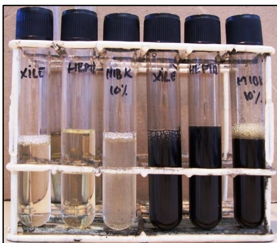
Figura 5. 1: Dissolucions al 10% d'oli lubricant nou amb xilè, heptà i MIBK i dissolucions al 10% d'oli lubricant usat amb xilè, heptà i MIBK, respectivament, just després de l'agitació.
