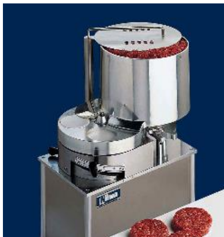
Figura 4.3: Màquina amb plat de moviment circular horitzontal [2]
