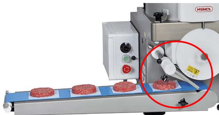
Figura 4.5: Màquina amb plat de moviment circular vertical [3]
