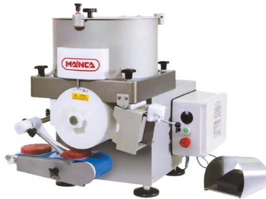
Figura 4.4: Màquina amb plat de moviment circular vertical [3]
