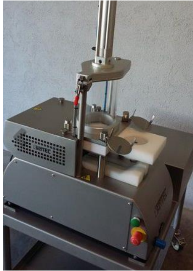
Figura 4.2: Màquina amb plat de moviment lineal [1]
