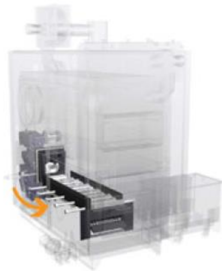
Fig. 47. Càmera de combustió i graella mòbil de la caldera Froling Turbomat on s'aprecia l'entrada de fums al nivell primari per sota de la graella mòbil. (Font: Froling)
