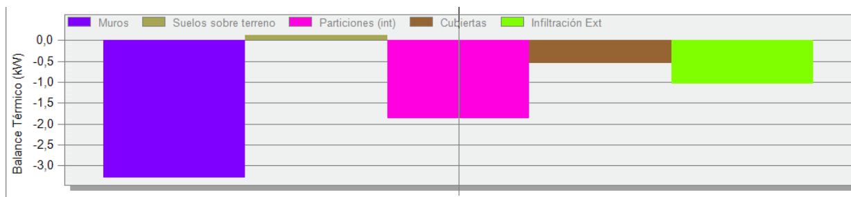
Fig 36. Pèrdues de calor durant del dia de disseny d'hivern d'una zona de vestidors
