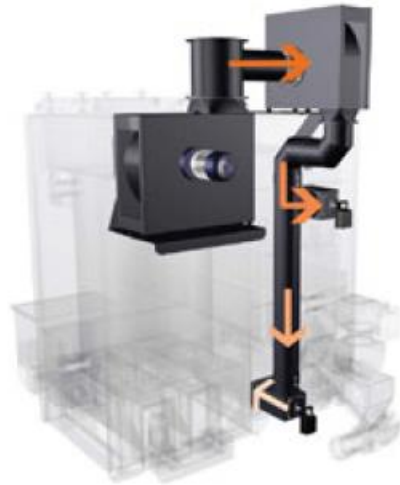
Fig. 46. Sistema de recirculació de fums de la caldera Turbomat on es veuen els servomotors que controlen la injecció en els nivells de combustió primari i terciari. (Font: Froling)
