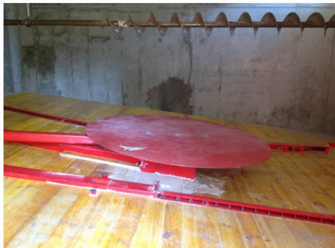
Fig. 44. Ballesta inclinada amb canal d'alimentació (vis sens fi). (Font: Web)
