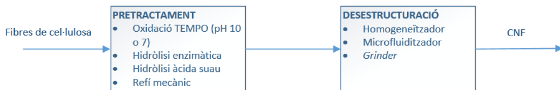
Figura 3-3 Esquema del procés de producció de les fibres de nanocel·lulosa.
