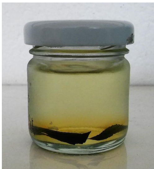
Figura 6-25 Mostres de PPyCNF-Fe submergides en un medi oxidant durant 30 h a 4 °C.
