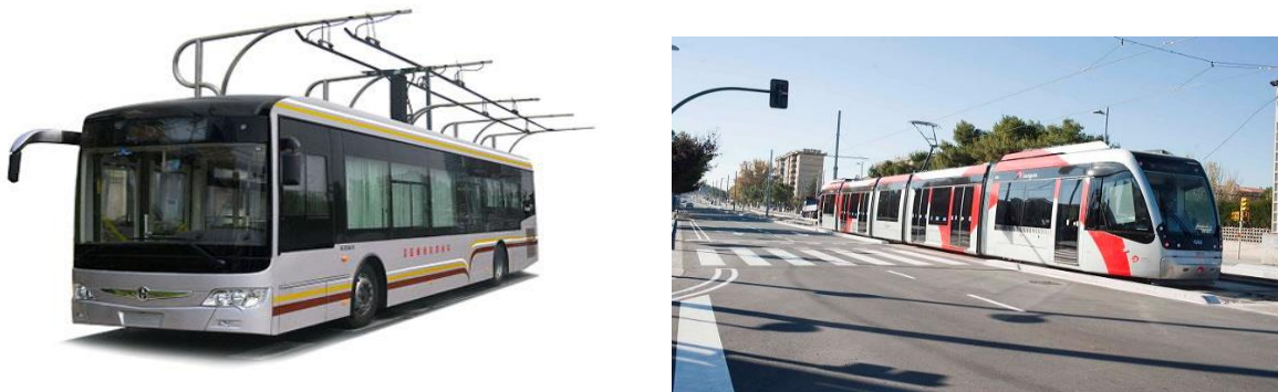
Figura 2-2 Vehicles que utilitzen exclusivament supercondensadors {3} {4}.
