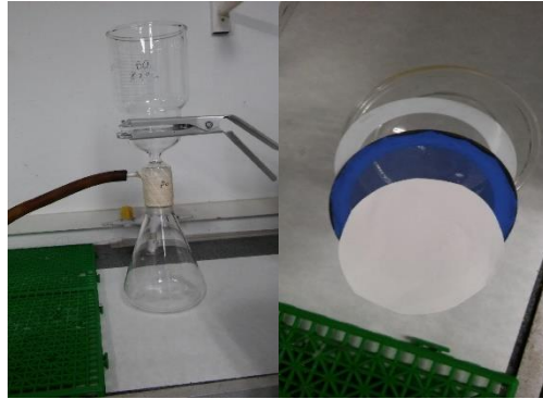
Figura 5-2 Muntatge de filtració al buit
