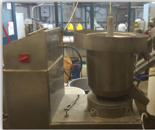
Figura 3.8 Procés de destintat del paper
