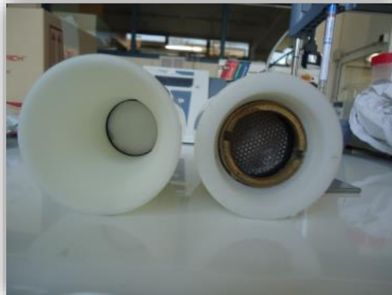
Figura 3.5 Dispositiu experimental per a la determinació del WRV
