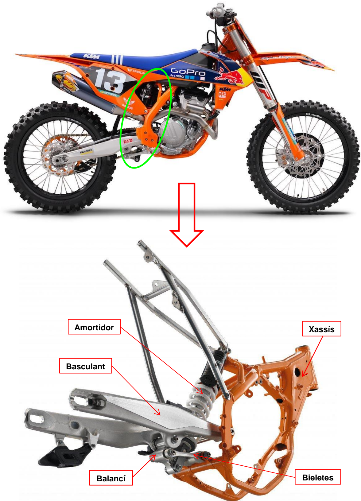
Figura 1.1.1. Moto de motocròs amb l'amortidor unit al basculant mitjançant el mecanisme format per les bieletes i el balanci.
