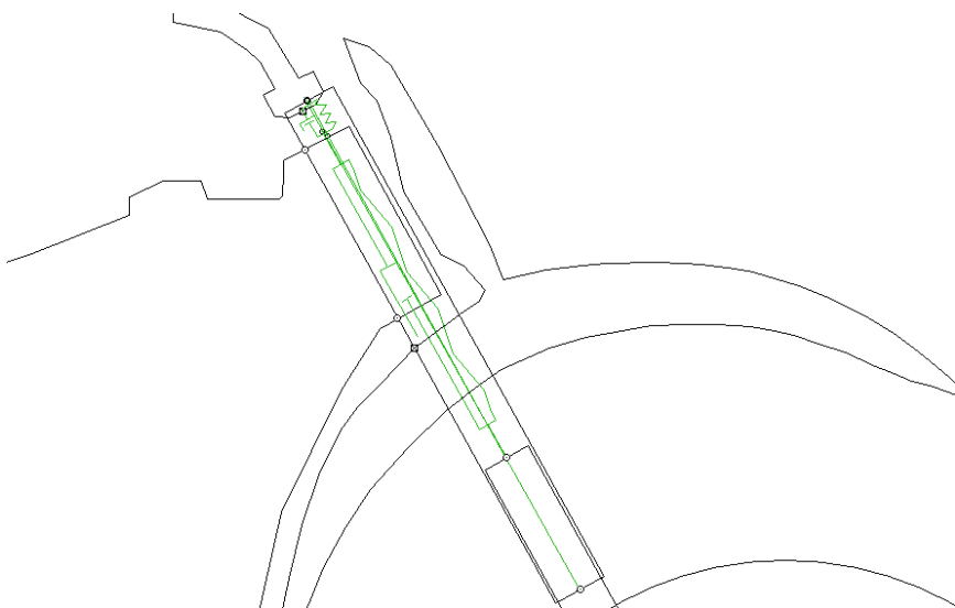
Figura 3.1.2.2. Suspensió amb doble molla-esmorteïdor per tal de simular el comportament progressiu de la suspensió real.
