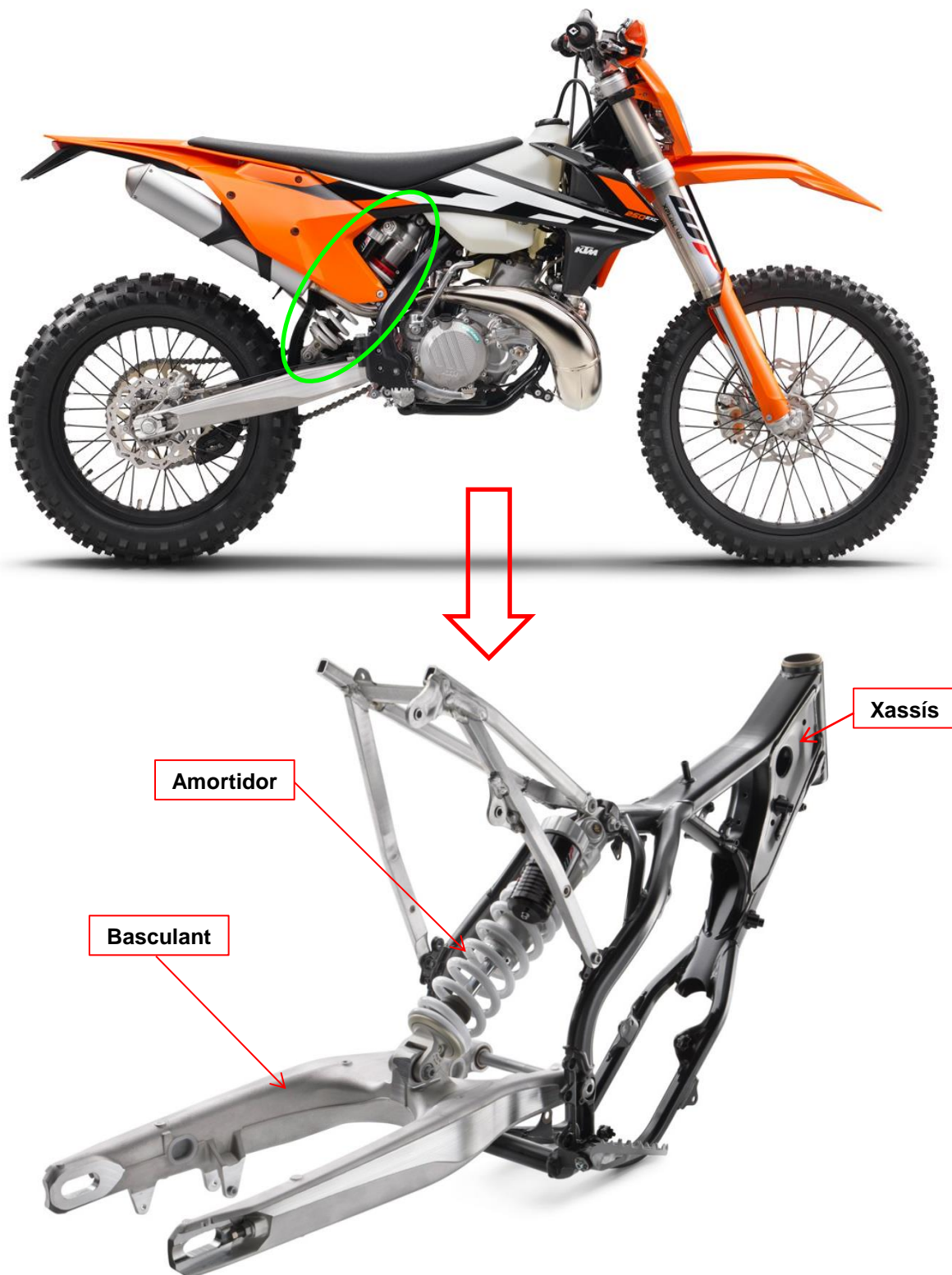
Figura 1.1.2. Moto d'enduro amb l'amortidor unit directament al basculant.
