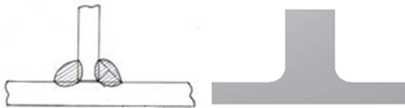
Figura 34: Simplificació del cordó de soldadura.
