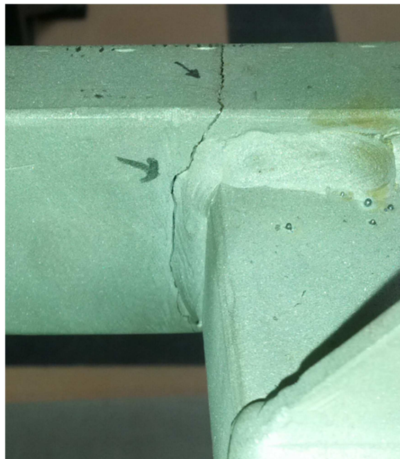
Figura 68: Esquerda i propagació en el punt (b)
