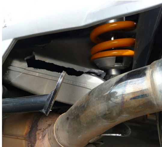
Figura 23: Exemple de ruptura d'un basculant a la zona pròxima a l'amortiguador.
