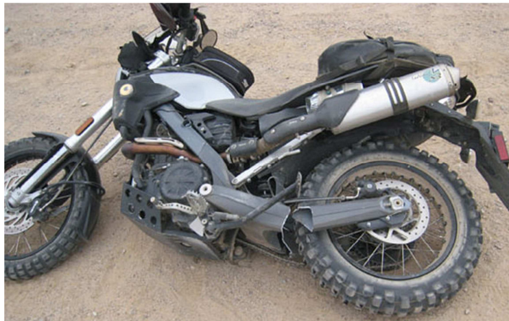
Figura 3: Exemple de ruptura d'un basculant.
