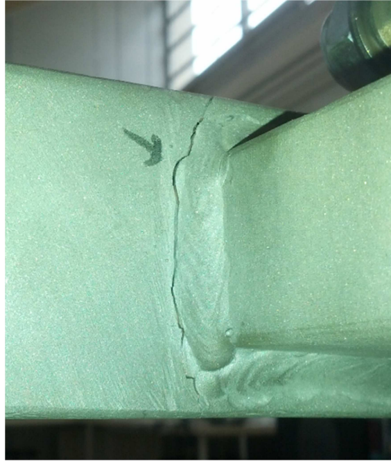
Figura 69: Propagació de l'esquerda cap a la part inferior.
