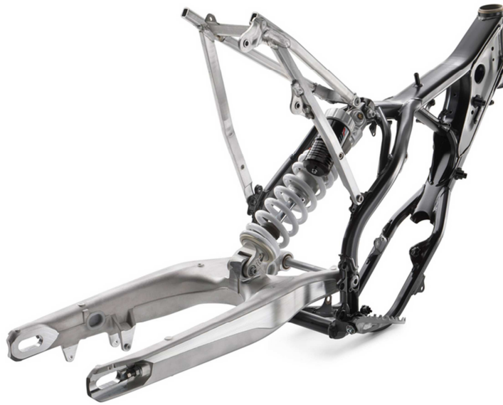
Figura 9: Basculant amb connexió directa entre l'amortiguador i el xassís.
