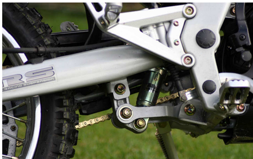
Figura 10: Basculant amb connexió amb l'amortiguador mitjançant bieletes.
