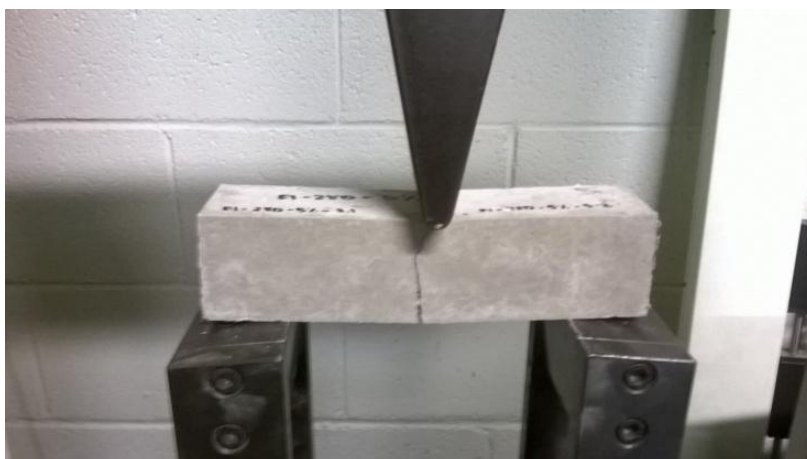
Fotografia 22: Realització de trencament a flexió. Font: pròpia
