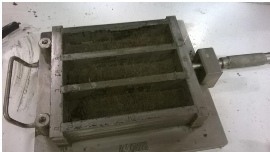
Fotografia 29: Proveta inicial amb manta de jute. Font: pròpia
