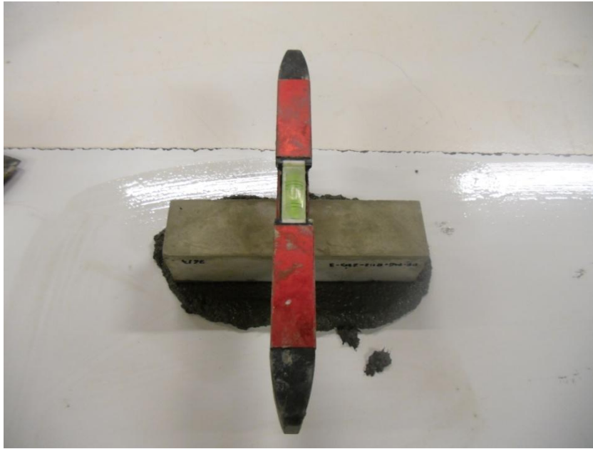
Fotografia 61: Anivellament de les cares durant el refractat 2. Font: pròpia
