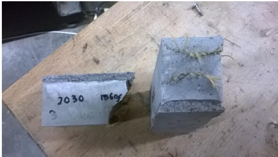
Fotografia 50: Proveta amb malla de jute de gramatge 135 g/m 2 . Font: pròpia
