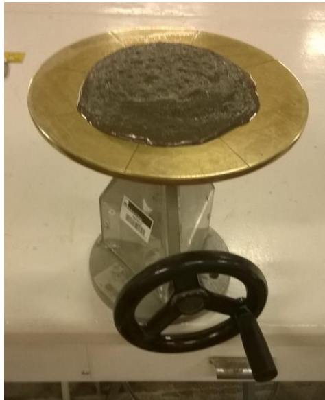
Fotografia 21: Exemple taula de sacsejades amb mostra de morter fresc. Font: pròpia
