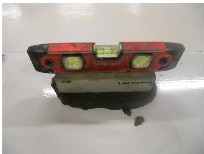
Fotografia 60: Anivellament de les cares durant el refractat. Font: pròpia
