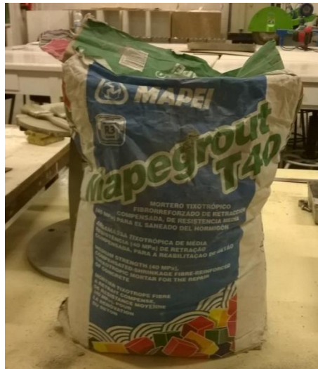
Fotografia 7: Morter tixotròpic per el refractat. Font: pròpia
