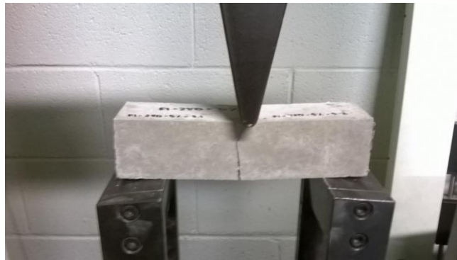
Fotografia 18: Premsa hidràulica de flexió. Font: pròpia.
