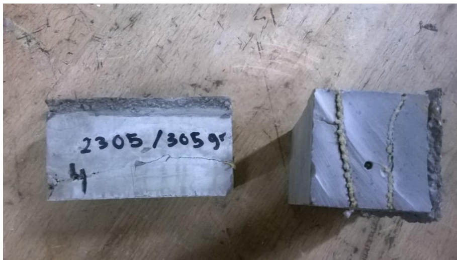
Fotografia 51: Proveta amb malla de jute de gramatge 305 g/m 2 . Font: pròpia
