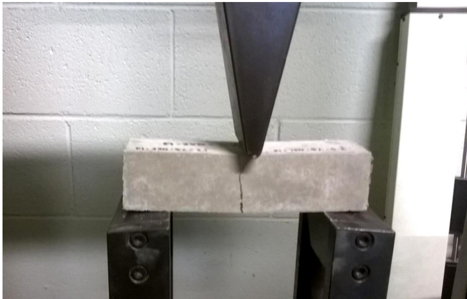
Fotografia 43: Assaig de resistència a flexió de proveta amb fibra afegida. Font: pròpia.
