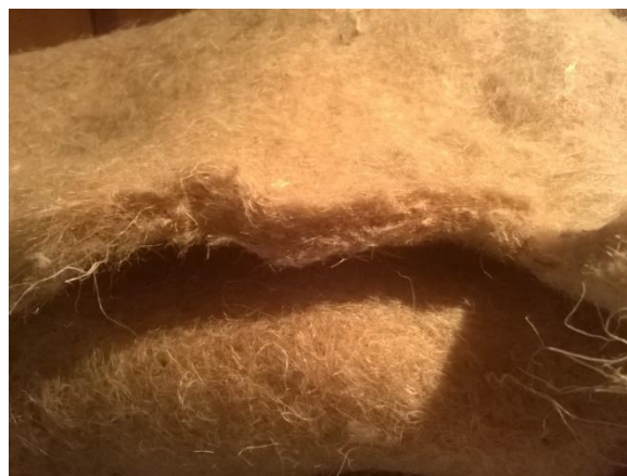
Fotografia 26: Manta de fibra de jute de gramatge 1200 g/m 2 . Font: pròpia
