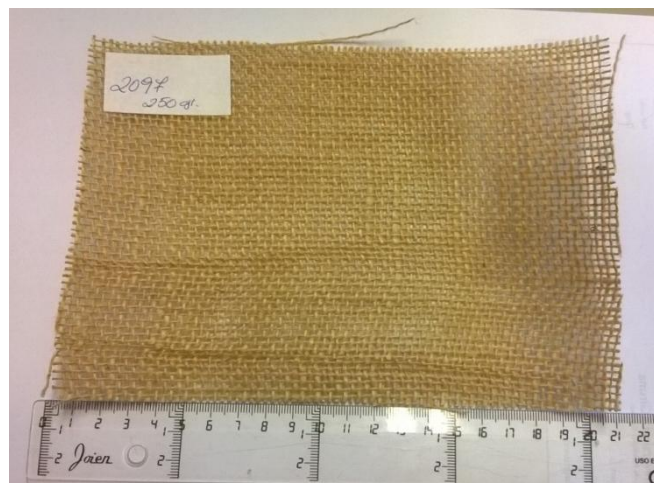
Fotografia 47: Malla de jute de gramatge 250 g/m2. Font: pròpia
