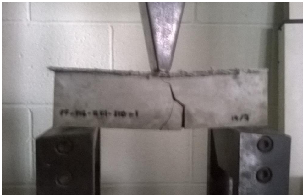
Fotografia 70: Assaig de resistència a flexió de proveta amb malla gran (82 g/m 2 ). Font: pròpia.
