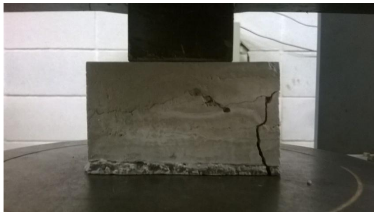
Fotografia 24: Exemple d'assaig a compressió de proveta amb malla. Font: pròpia.
