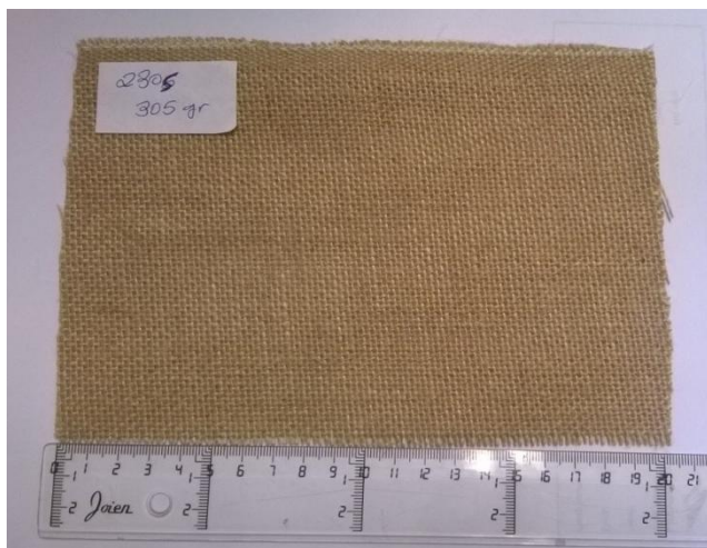
Fotografia 48: Malla de jute de gramatge 305 g/m2. Font: pròpia
