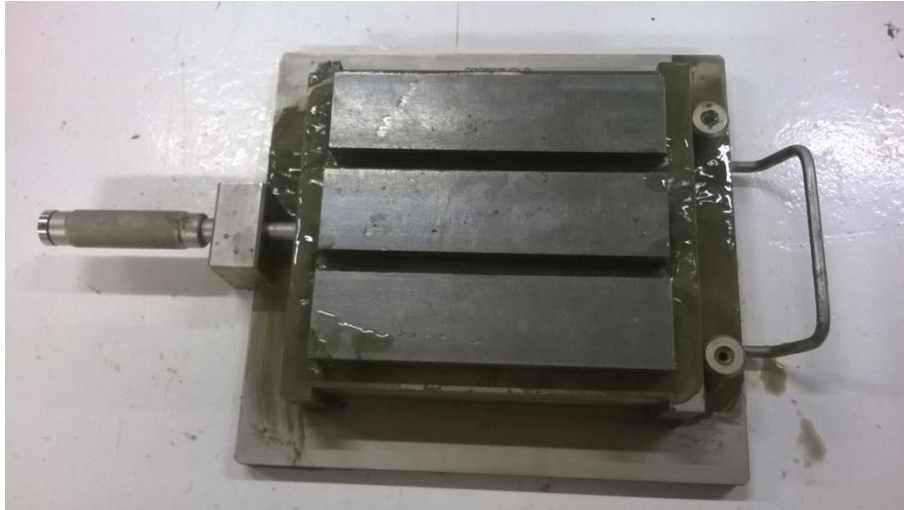
Fotografia 27: Motlle normalitzat amb els prismes rectangulars premsant la mescla. Font: pròpia
