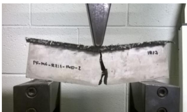
Fotografia 66: Assaig de resistència a flexió de proveta amb fibra afegida. Font: pròpia.
