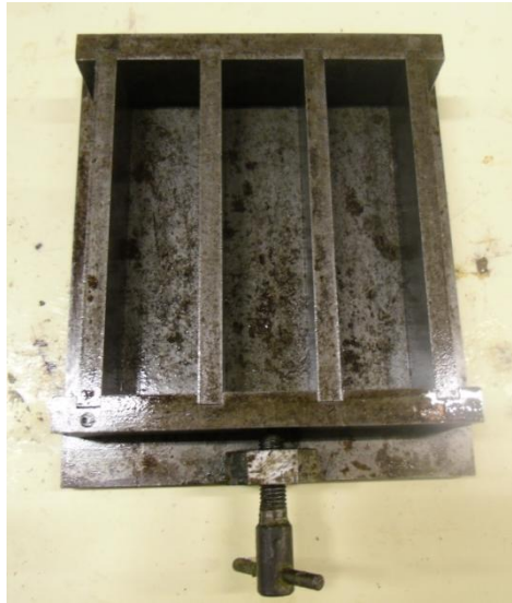
Fotografia 3: Motlles d'acer per realitzar les provetes. Font: pròpia
