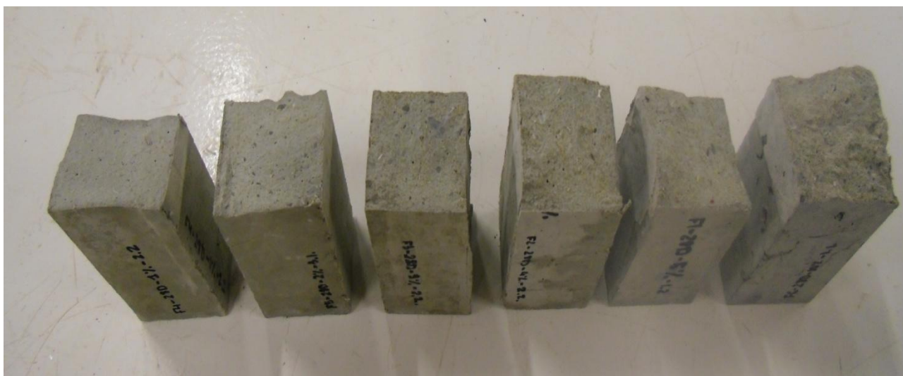
Fotografia 34: Exemple de provetes amb augment de fibra addicionada. Font: pròpia
