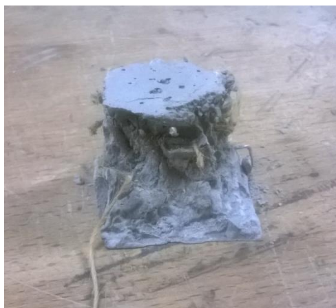
Fotografia 25: Exemple d'anàlisi del tipus de ruptura. Font: pròpia
