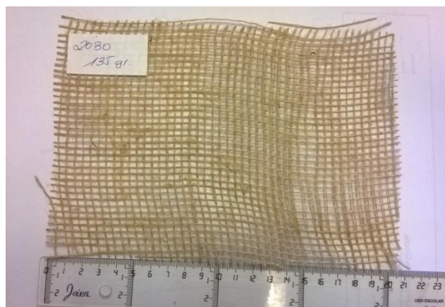
Fotografia 44: Malla de jute de gramatge 135 g/m 2 . Font: pròpia
