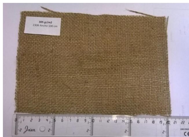
Fotografia 46: Malla de jute de gramatge 305 g/m2. Font: pròpia
