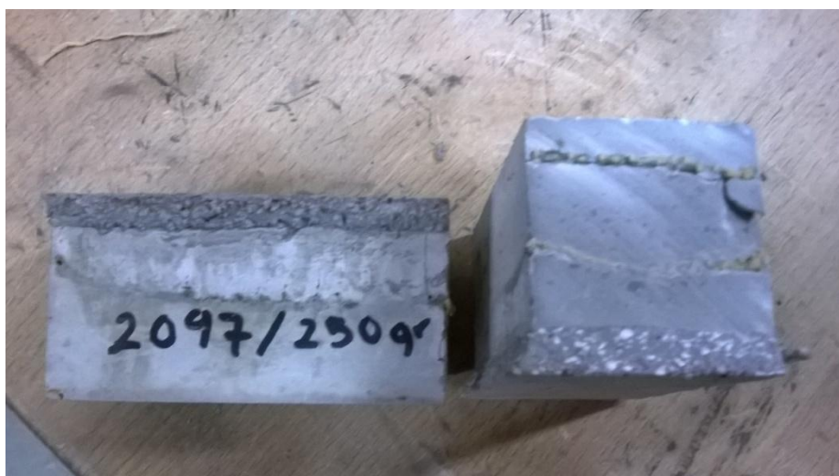
Fotografia 52: Proveta amb malla de jute de gramatge 250 g/m 2 . Font: pròpia
