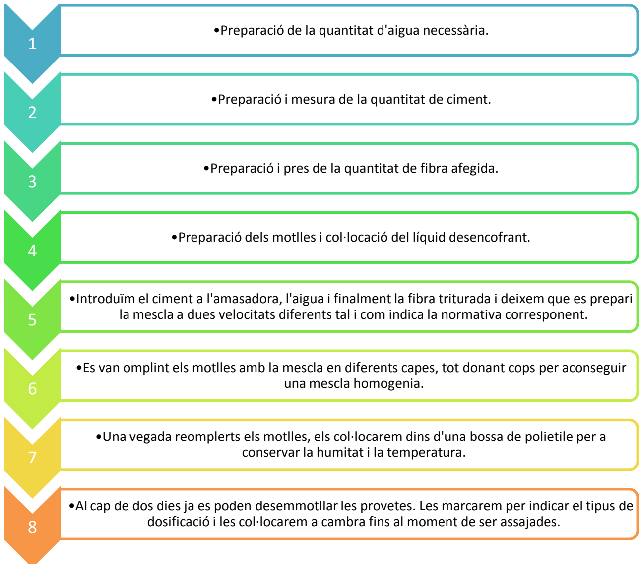
Diagrama 4: Procediment operatiu per a la fabricació de les provetes amb fibra. Font: pròpia
