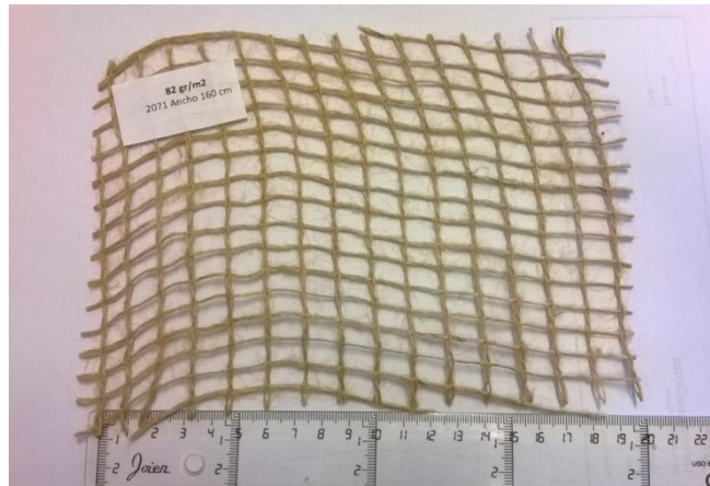
Fotografia 45: Malla de jute de gramatge 82 g/m2. Font: pròpia
