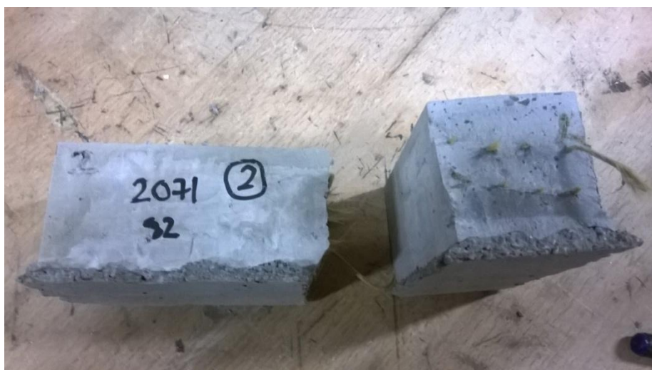
Fotografia 49: Proveta amb malla de jute de gramatge 82 g/m2. Font: pròpia
