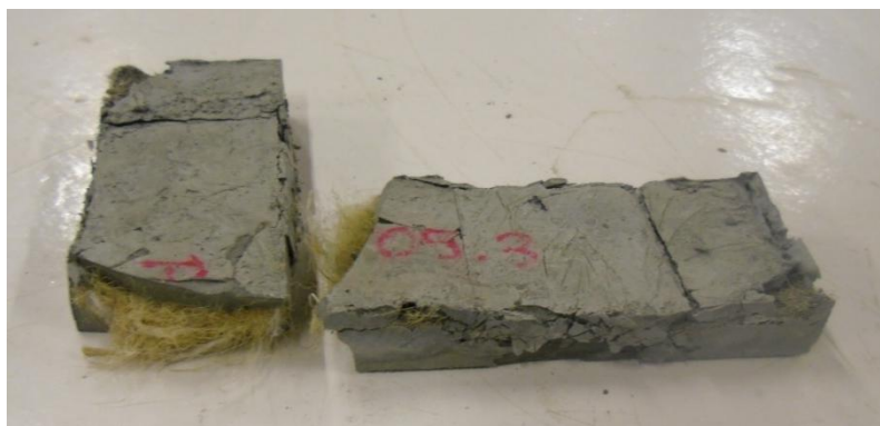
Fotografia 32: Mostra realitzada amb manta de jute de 500 g/m 2 . Font: pròpia
