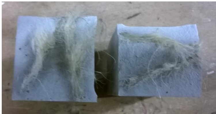
Fotografia 33: Mostra realitzada amb manta de jute de 200 g/m 2 . Font: pròpia
