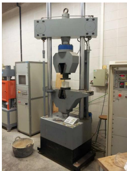
Fotografia 17: Premsa universal de 60 tones. Font: pròpia.
