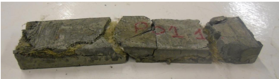
Fotografia 31: Mostra realitzada amb manta de jute de 1200 g/m 2 . Font: pròpia
