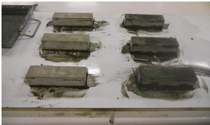
Fotografia 62: Resultat final del refractat en provetes en malla. Font: pròpia
