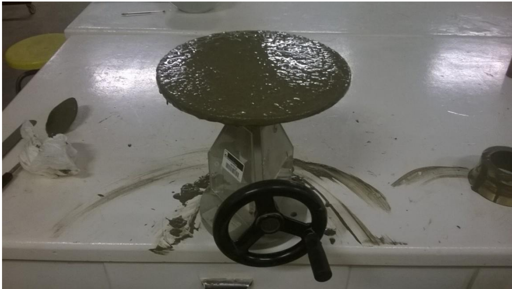
Fotografia 35: Assaig de consistència del ciment blanc a R 1:1,5. Font: pròpia.
