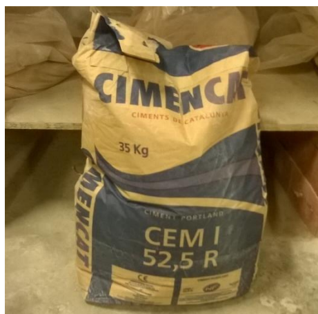
Fotografia 2: Ciment pòrtland Tipus I. Font: pròpia
