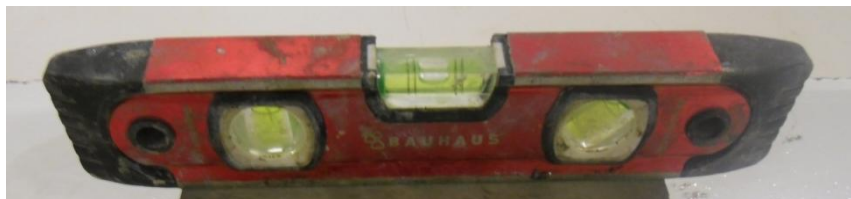
Fotografia 8: Nivell utilitzat en el refractat de provetes. Font: pròpia
