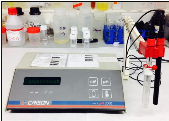
Figura 6. Equip instrumental. Elèctrode selectiu d'ions (ISE - Crison, Spain).
