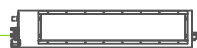
ZONA D'AMPLIACIÓ (conductes) FXSQ100M Potència frigorífica: 11.2 kW Potència calorífica: 12.5 kW Cabal: 1680 m 3 /h
