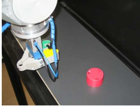
Figura 5.4. El braç apropant-se a la peça que ha d'agafar
