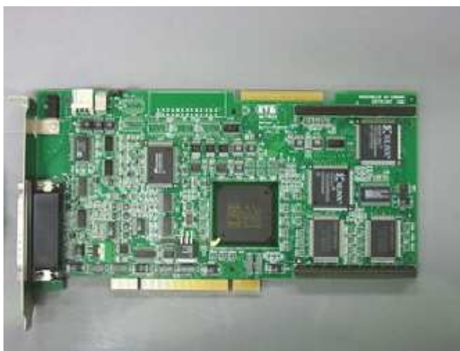
Figura 2.8. Targeta d'adquisició d'imatges Matrox Meteor II
