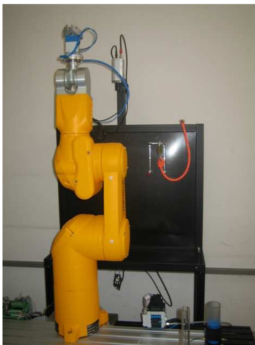
Figura 2.1. Braç manipulador Stäubli TX60 utilitzat en el desenvolupament del projecte
