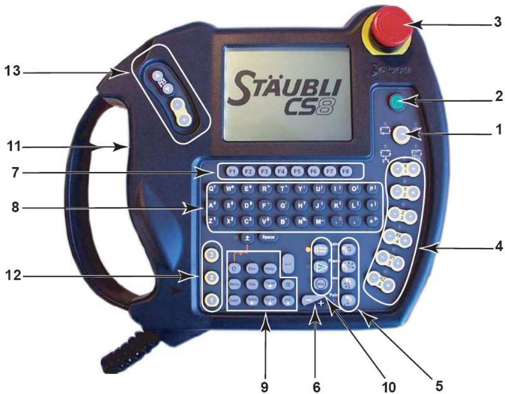
Figura 2.6. Distribució del teclat de la MCP
