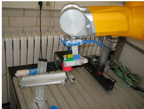
Figura 5.5. El braç deixant la peça al seu lloc
