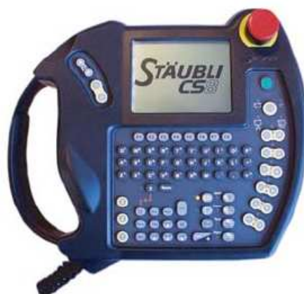
Figura 2.4. Manual Control Pendant
