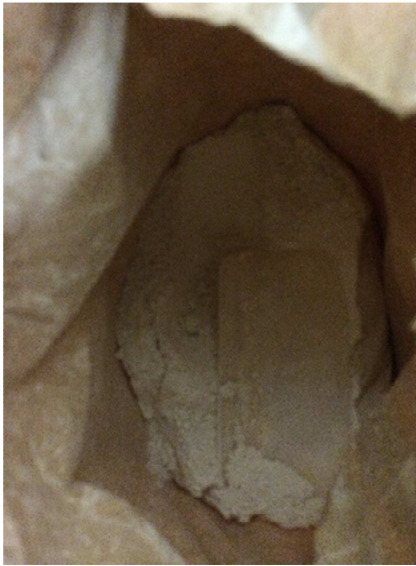
Imatge 3.7: Filler de carbonat de calci utilitzat per la reacció química. Font : Pròpia
