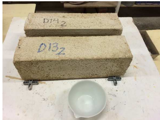
Imatge 3.10: Proveta prismàtica col·locada sobre els suports de PVC, i vol per preparar la reacció química. Font : Pròpia
