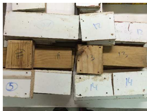
Imatge 2.9: Peces numerades per posterior muntatge dels motlles Font : Pròpia
