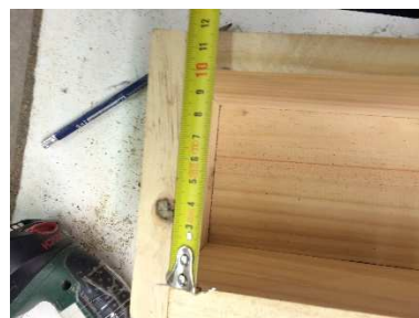
Imatge 2.13: Comprovació dimensions transversals del motlle. Font : Pròpia
