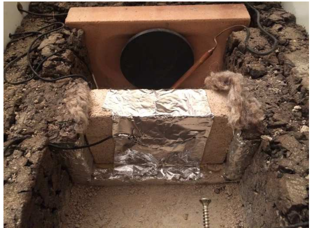
Imatge 3.50: Proveta amb termòmetres col·locats. Font : Pròpia
