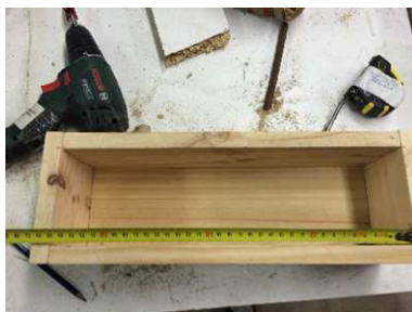
Imatge 2.12: Comprovació dimensions longitudinals del motlle. Font : Pròpia
