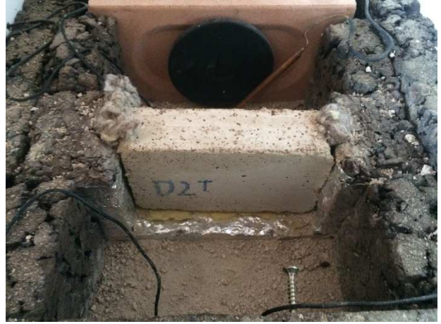
Imatge 3.48: Proveta col·locada a la caixa tèrmica calibrada. Font : Pròpia
