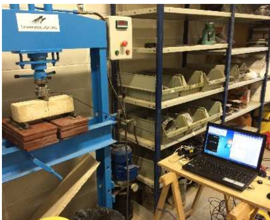
Imatge 3.25: Vista general dels equips i estris necessaris per realitzar l'assaig de resistència a flexió. Font : Pròpia
