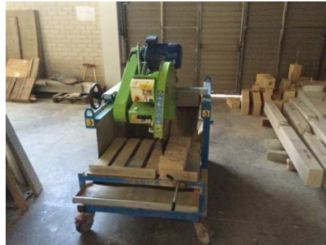
Imatge 3.31: Tall de peces de l'assaig de flexió per posteriorment realitzar l'assaig de compressió. Font : Pròpia
