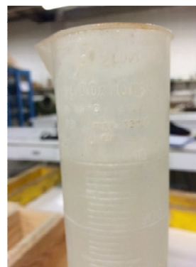
Imatge 2.20: Proveta amb exactament 1000 ml d'aigua. Font : Pròpia
