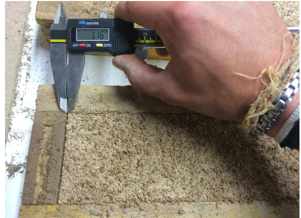
Imatge 3.5: Mesura de la retracció de la banda esquerra d'una proveta de retracció. Font : Pròpia
