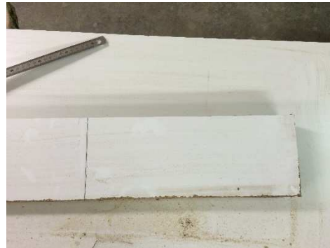
Imatge 2.7: Base del motlle marcada preparada per tallar Font : Pròpia
