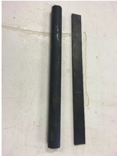
Imatge 3.16: Platina rectangular per evitar l'enclavament i rodet de càrrega. Font : Pròpia
