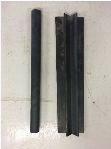
Imatge 3.15: Rodet de suport articulad, base i rodet per assaig a flexió. Font : Pròpia
