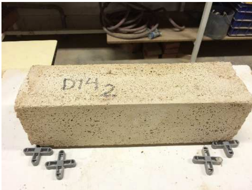
Imatge 3.9: Proveta prismàtica col·locada sobre els suports de PVC. Font : Pròpia
