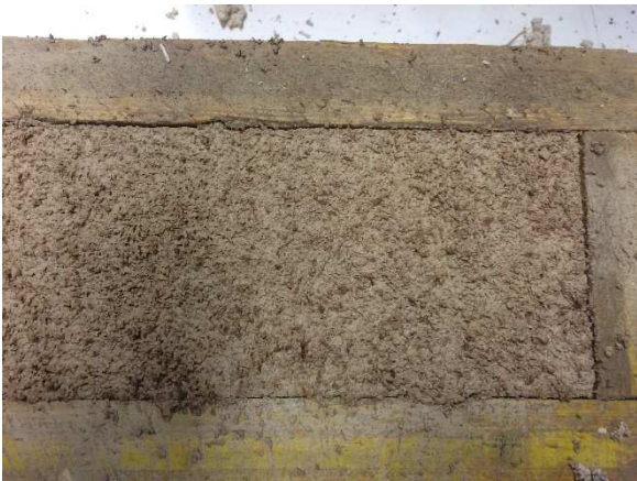
Imatge 3.4: Retracció de la banda dreta d'una proveta de retracció. Font : Pròpia
