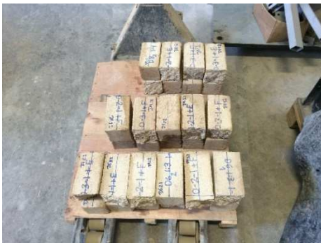
Imatge 3.30: Provetes després de l'assaig de flexió abans de ser tallades. Font : Pròpia
