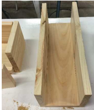
Imatge 2.10: Lateral del motlle cargolat a la base. Font : Pròpia
