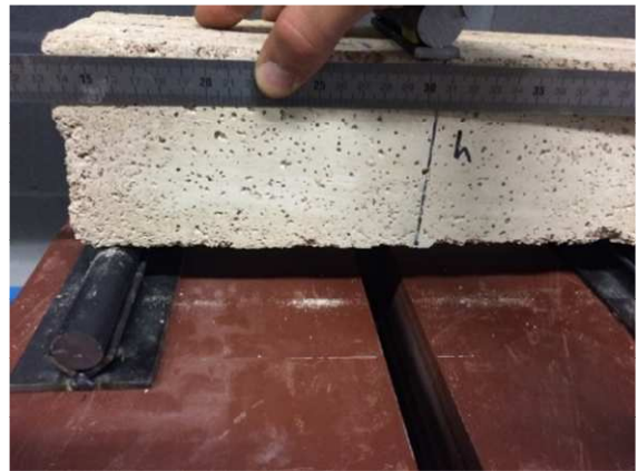
Imatge 3.22: Comprovació de la distància del punt d'aplicació de la càrrega. Font : Pròpia
