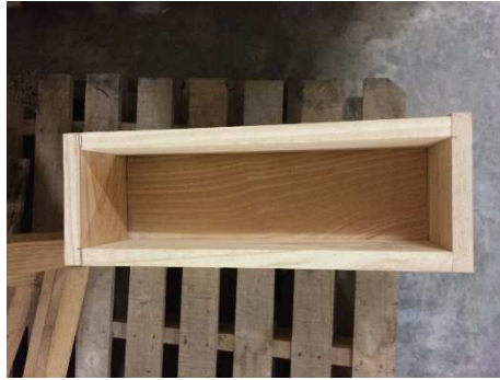
Imatge 2.14: Motlle acabat després del procés de rectificat. Font : Pròpia
