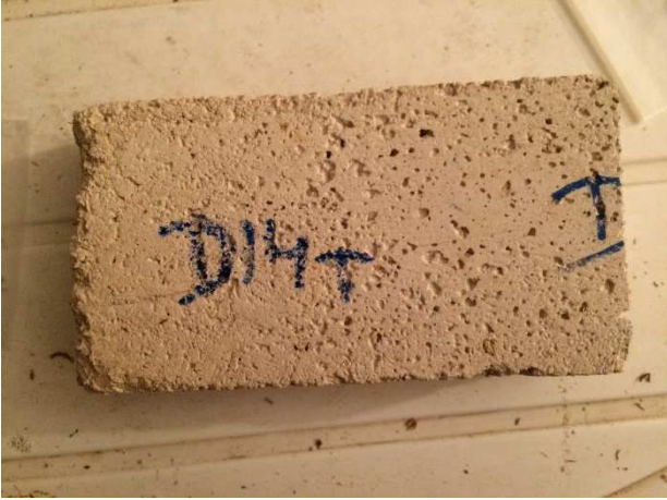
Imatge 3.47: Proveta per sotmetre a l'assaig tèrmic. Font : Pròpia
