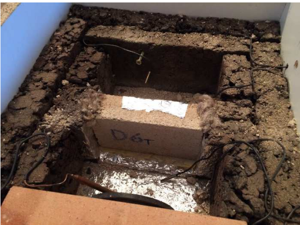
Imatge 3.49: Proveta col·locada a la caixa termòmetre cara freda fixat, termòmetre cara calenta abans de fixar. Font : Pròpia
