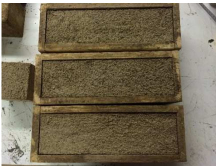
Imatge 2.23: Provetes preparades per desencofrar. Font : Pròpia
