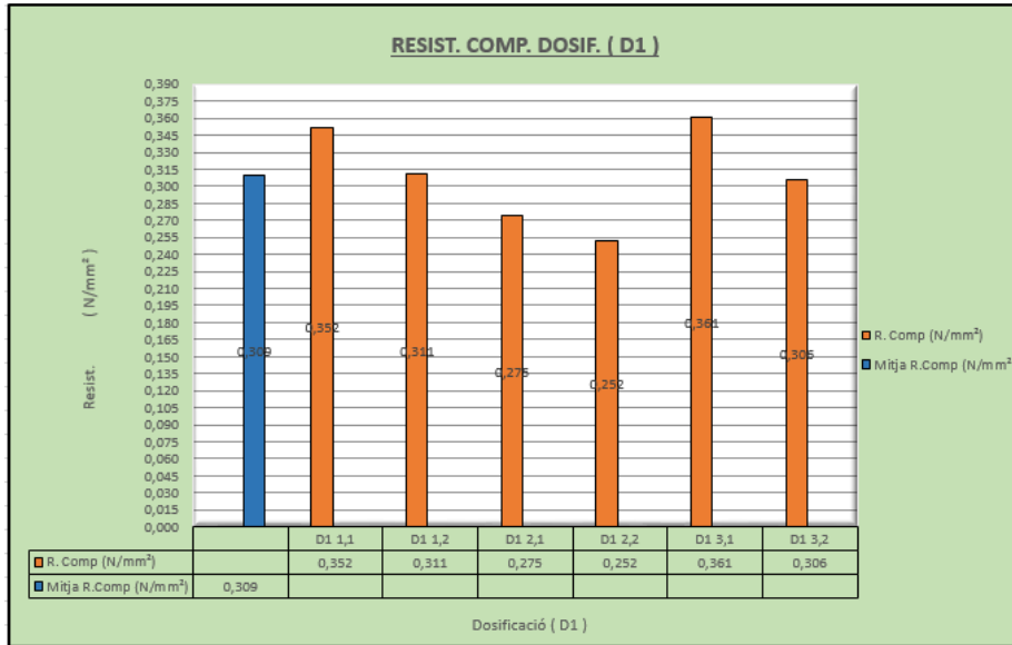
Imatge 3.34: Gràfica de resistència a compressió de la proveta D1. Font : Pròpia
