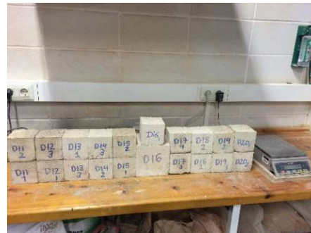
Imatge 3.33: Mesura de les masses de les provetes assecades a l'estufa. Font : Pròpia
