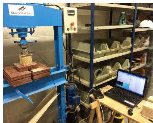
Imatge 3.41: Equip i útils per la realització de l'assaig a compressió. Font : Pròpia
