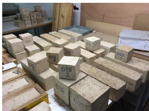
Imatge 2.28: Emmagatzematge de les provetes abans de sotmetre-les a assaig. Font : Pròpia
