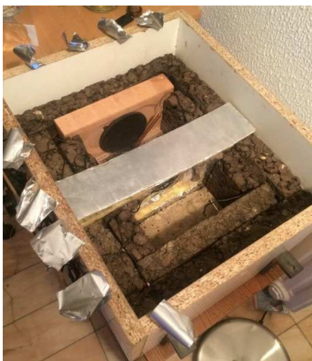
Imatge 3.51: Proveta preparada per sotmetre's a l'assaig tèrmic. Font : Pròpia
