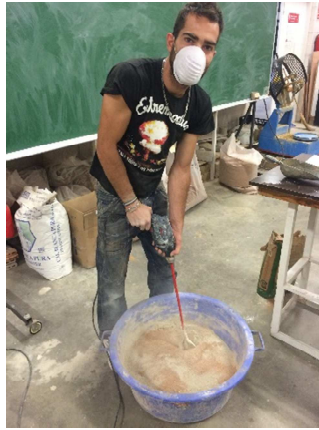
Imatge 2.18: Barreja en sec d'una de les dosificacions realitzades. Font : Guillem Martí
