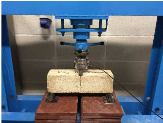
Imatge 3.23: Proveta correctament col·locada abans d'iniciar l'assaig a flexió. Font : Pròpia
