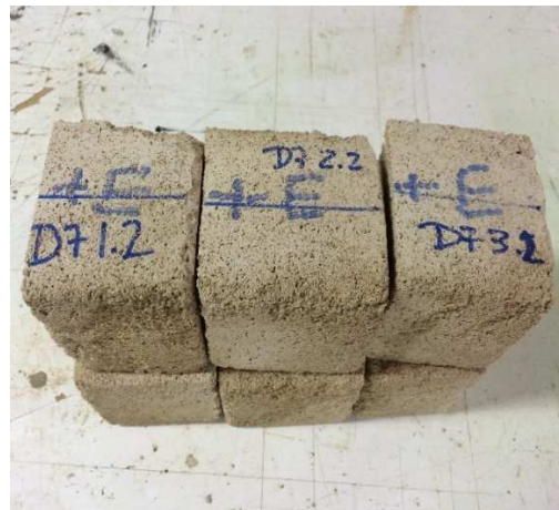
Imatge 3.36: Referències d'una sèrie de provetes per l'assaig de resistència a compressió. Font : Pròpia
