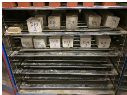
Imatge 3.32: Assecat de provetes a l'estufa abans de l'assaig de compressió. Font : Pròpia
