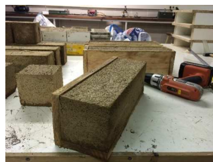
Imatge 2.24: Desencofrat de provetes. Font : Pròpia
