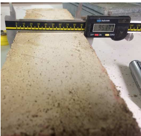
Imatge 2.30: Mesura transversal de la proveta per marcar l'eix longitudinal. Font : Pròpia
