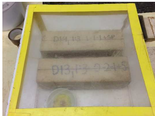
Imatge 3.12: Provetes exposades a la reacció química. Font : Pròpia
