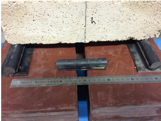
Imatge 3.21: Col·locació de la proveta sobre els rodets de suport, i verificació de la distància d'assaig. Font : Pròpia
