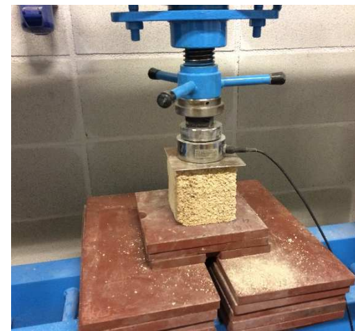
Imatge 3.40: Proveta preparada abans d'iniciar l'assaig de resistència a compressió. Font : Pròpia
