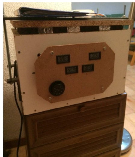
Imatge 3.52: Caixa tèrmica calibrada utilitzada per realitzar l'assaig. Font : Pròpia
