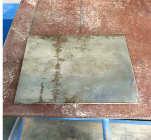
Imatge 3.38: Platina metàl·lica utilitzada per repartir la càrrega en la proveta en l'assaig de resistència a compressió. Font : Pròpia
