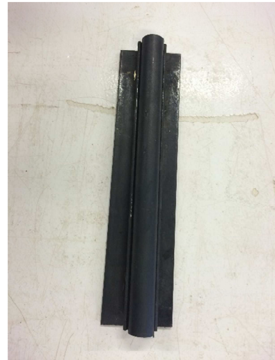
Imatge 3.17: Rodet de suport fix per assaig a flexió. Font : Pròpia
