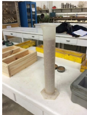
Imatge 2.16: Proveta utilitzada per l'aportació volumètrica dels materials. Font : Pròpia
