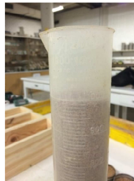
Imatge 2.17: Proveta emplenada amb suro fins a 1000 ml. Font : Pròpia
