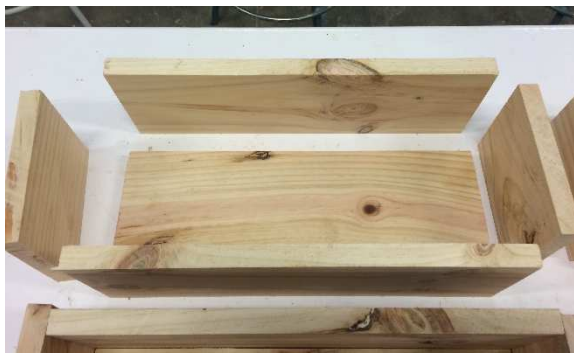
Imatge 2.5: Peces de Pi de flandes necessàries per fabricar els motlles Font : Pròpia
