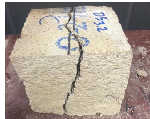
Imatge 3.42: Ruptura d'una proveta sotmesa a l'assaig de resistència a compressió. Font : Pròpia
