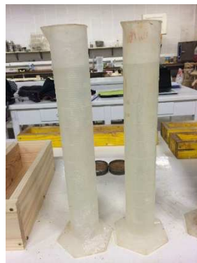
Imatge 2.19: Proveta utilitzades per l'addició d'aigua a la mostra. Font : Pròpia
