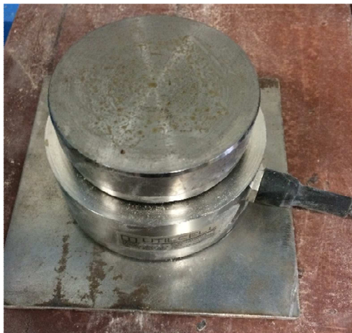
Imatge 3.39: Cèdula de càrrega i platina preparades per col·locar a sobre la proveta. Font : Pròpia
