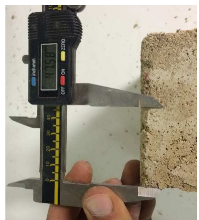
Imatge 2.32: Verificació del punt mig de la proveta per posteriorment mesurar-la. Font : Pròpia
