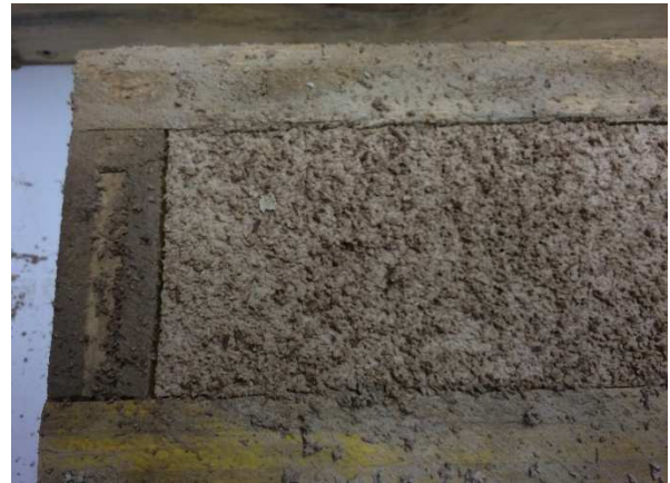
Imatge 3.3: Retracció de la banda esquerra d'una proveta de retracció. Font : Pròpia
