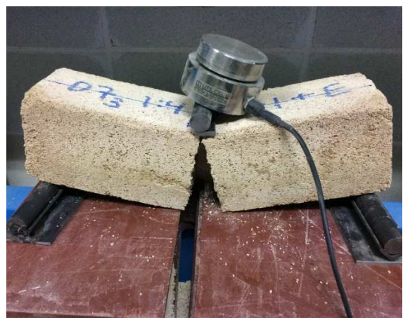
Imatge 3.26: Ruptura d'una proveta sotmesa a l'assaig de resistència a flexió. Font : Pròpia
