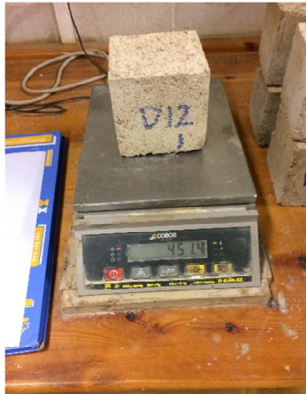
Imatge 2.34: Mesura de la massa de les provetes. Font : Pròpia
