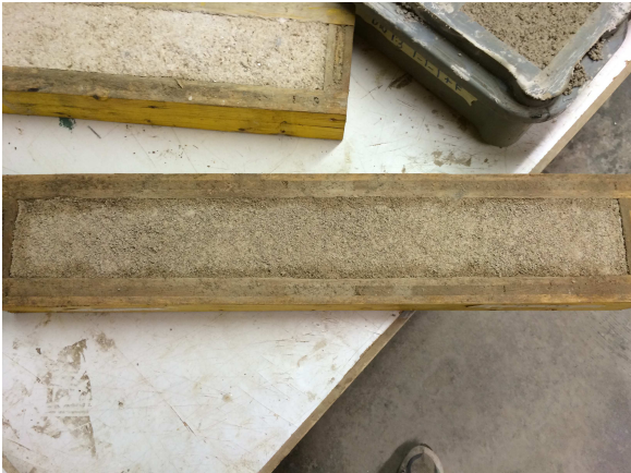
Imatge 3.2: Proveta de retracció. Font : Pròpia
