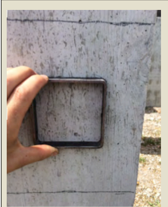
Imatge 4.54: Col·locant superfície de 100cm 2 dins la superfície de 666,66 cm 2 .
