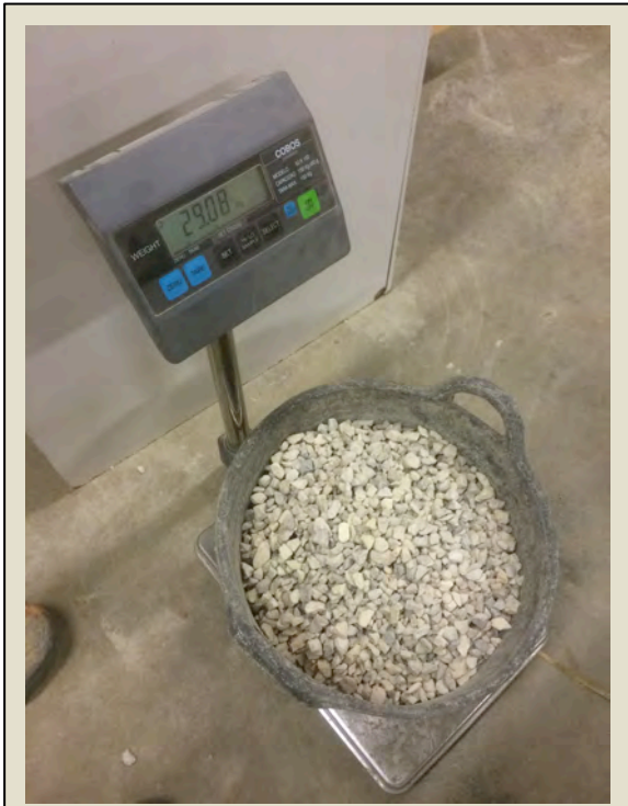
Imatge 3.2.13: Preparació dosificació per amassada. Pesada grava 10-20mm. Foto: Albert Coromina / Font: Pròpia
