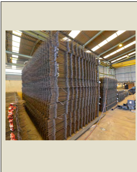
Imatge 3.1.7 : Pila de Mallatzo.
