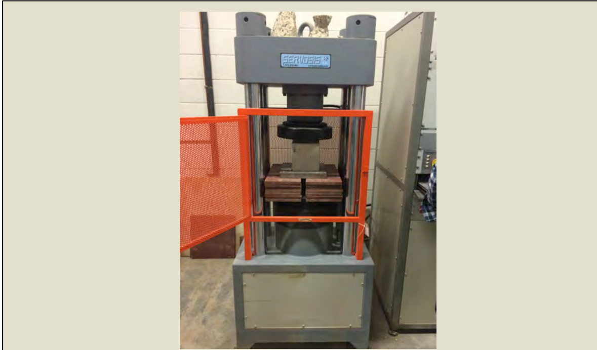
Imatge 4.59: Premsa per l'assaig a compressió del laboratori de la UdG. Foto: Albert Coromina / Font: Pròpia
