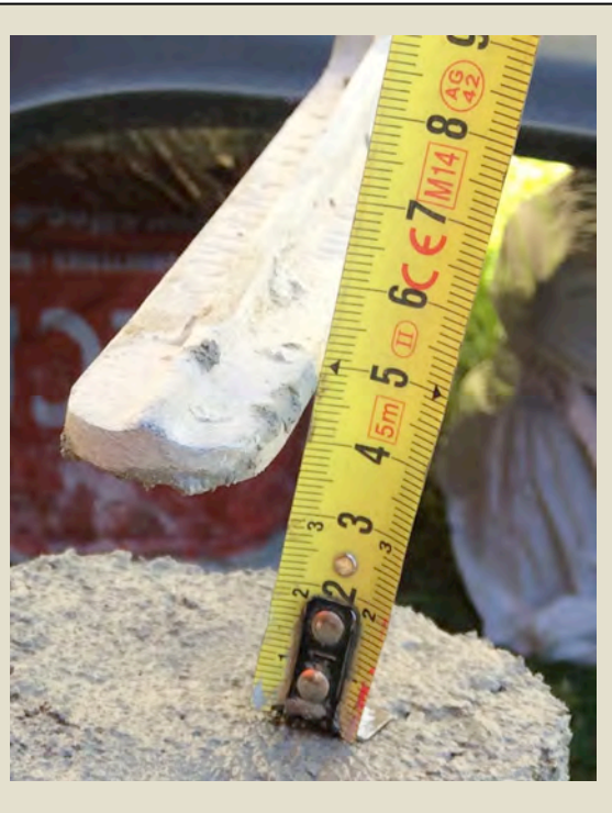
Imatge 4.41: Assentament (1) 4,5cm. Foto: Albert Coromina / Font: Pròpia
