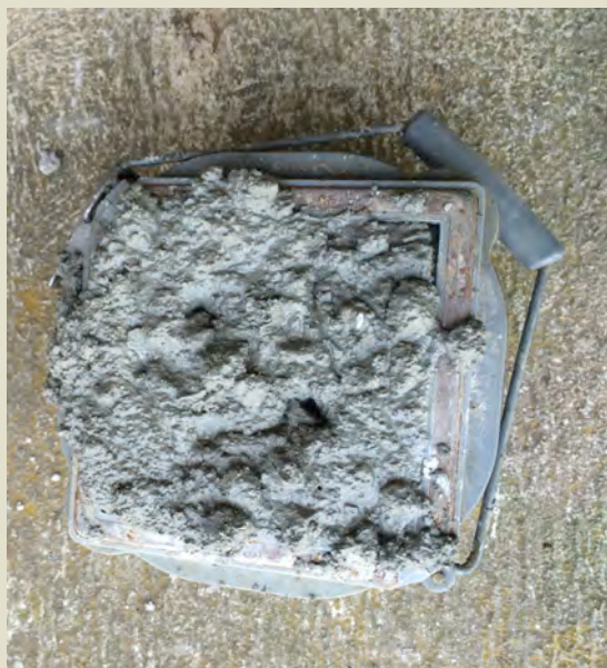
Imatge 5.1.2.24: Fabricació de provetes segons UNE –EN 12390-2: 2009. Foto: Albert Coromina / Font: Pròpia
