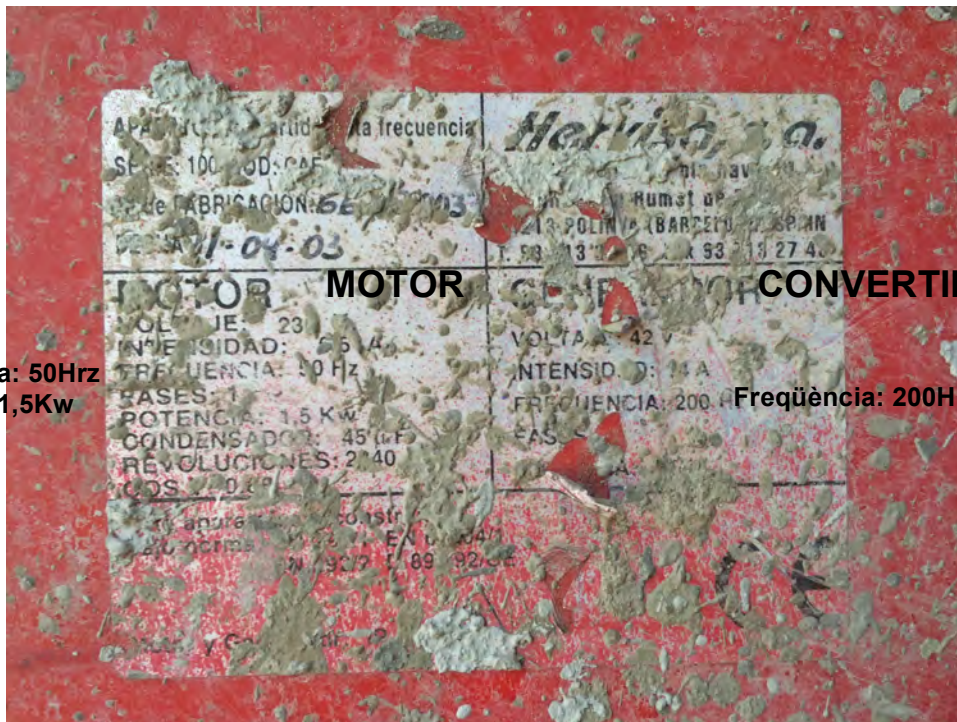
Imatge 5.3.1.2: Dades tècniques vibrador utilitzat assaig 3.
