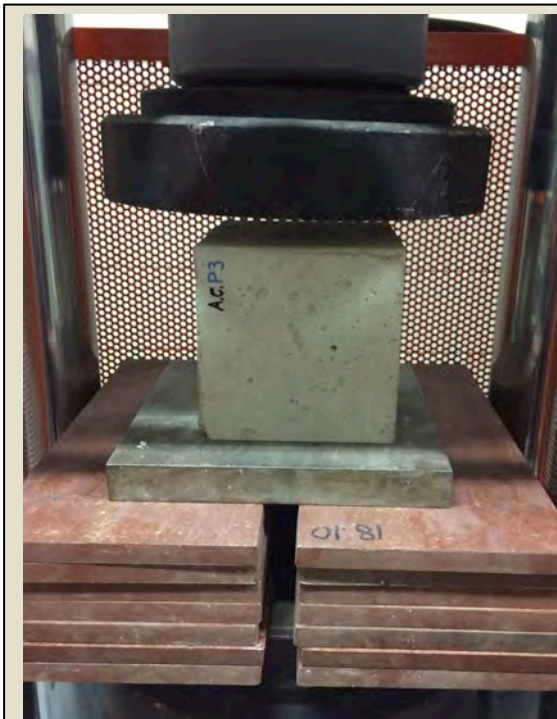
Imatge 3.3.5: Proveta amassada 3 col·locada a la premsa ACP3. Foto: Albert Coromina / Font: Pròpia
