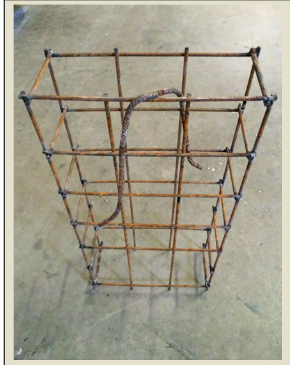
Imatge 4.14: Armat proveta acabat.
