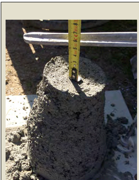
Imatge 4.42: Assaig 2 con d'Abrams segons (UNE-EN 12350-2). Consistència tova (5-10). Foto: Albert Coromina / Font: Pròpia
