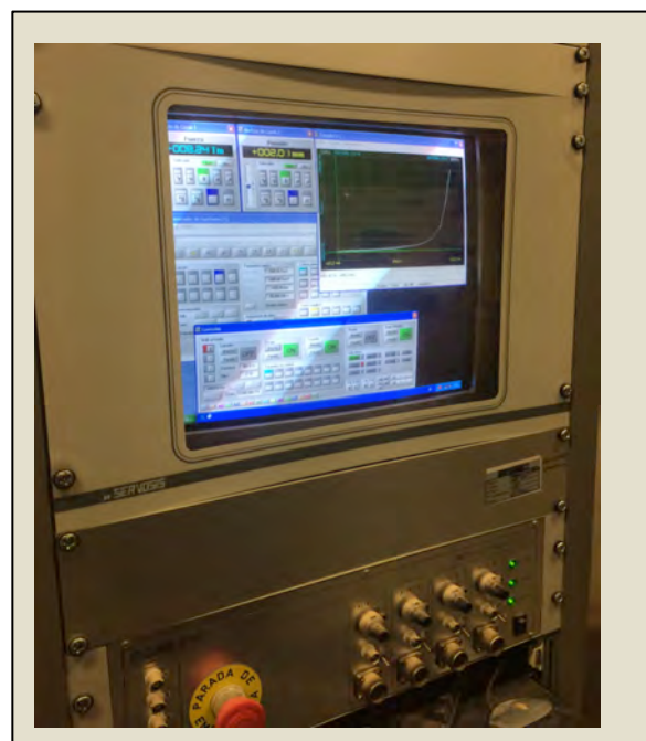
Imatge 4.61: Programa informàtic de control de la premsa del laboratori de la UdG. Foto: Albert Coromina / Font: Pròpia
