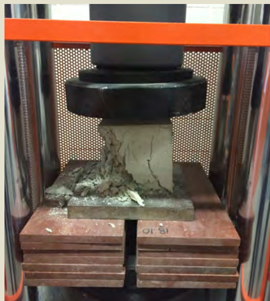
Imatge 3.3.6: Trencament de la proveta ACP3. Foto: Albert Coromina / Font: Pròpia
