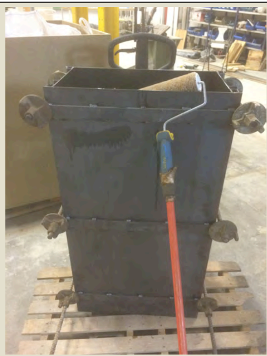
Imatge 3.2.8: Untat proveta amb oli desencofrant.
