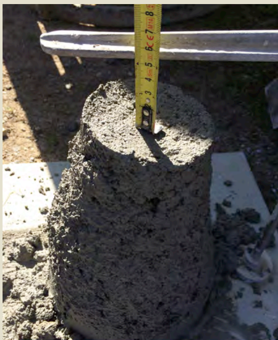
Imatge 5.1.2.22: Assaig 2 con d'Abrams segons (UNE-EN 12350-2). Consistència tova (5-10).
