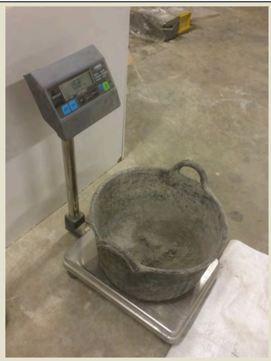
Imatge 3.2.10: Preparació dosificació per amassada. Pesada ciment II A-L 42,5.
