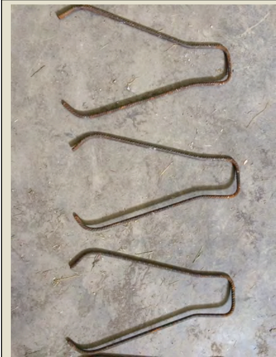
Imatge 4.13: Elements per moure la proveta una vegada formigonada i curada amb el camió ploma.
