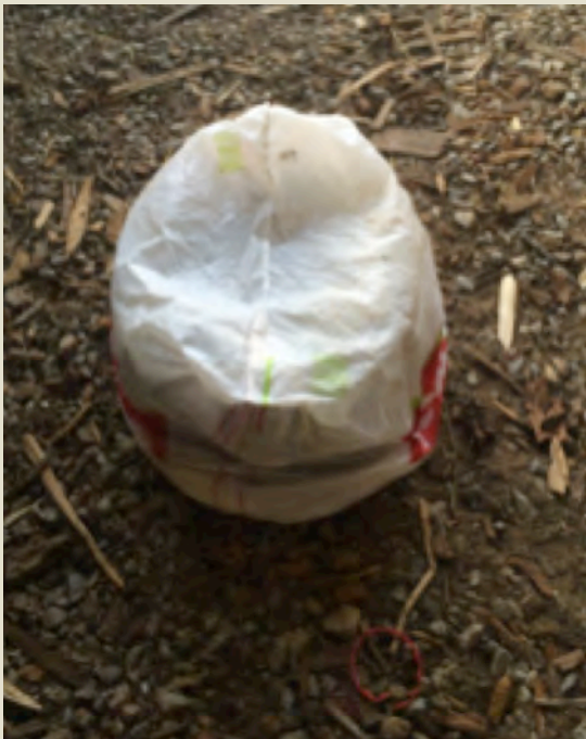
Imatge 4.46: Proveta tapada i a l'ombra durant 48 hores. Foto: Albert Coromina / Font: Pròpia
