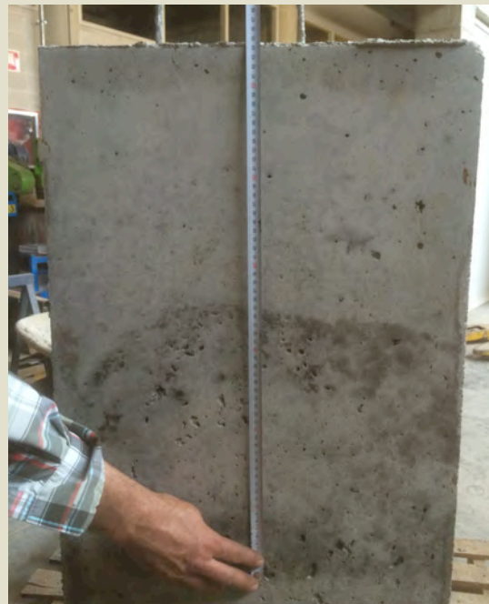
Imatge 3.2.47: Canvi tonalitat amassada 2 i 3. Foto: Albert Coromina / Font: Pròpia
