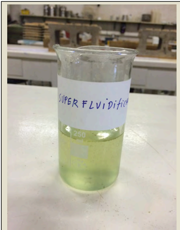
Imatge 3.2.18 : Superfluidificant Glenium ACE 425. Foto: Albert Coromina / Font: Pròpia
