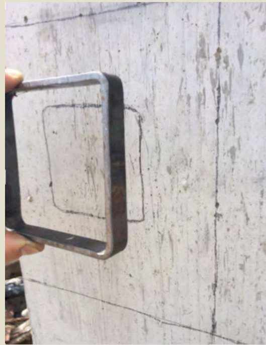
Imatge 4.55: Marcant la superfície de 100cm 2 .
