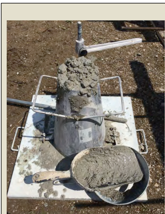
Imatge 5.2.2.19: Assaig (2) con d'Abrams segons (UNE-EN 12350-2). Consistència fluida (8-17).
