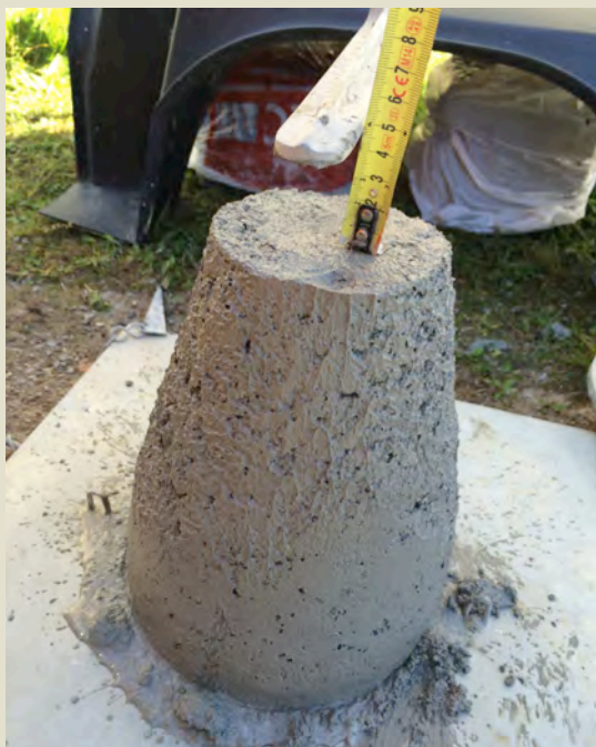
Imatge 5.1.2.20: Assaig 1 con d'Abrams segons (UNE-EN 12350-2). Consistència tova (5-10).
