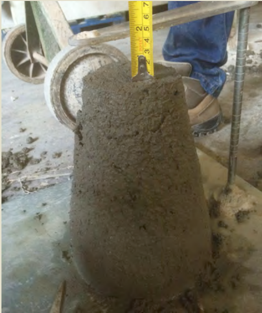
Imatge 3.2.33 : Assaig con d'Abrams segons (UNE-EN 12350-2). Consistència plàstica (3-5) Amassada 2. Foto: Albert Coromina / Font: Pròpia
