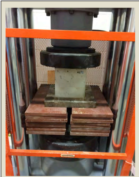
Imatge 3.3.3: Proveta amassada 2 col·locada a la premsa ACP2. Foto: Albert Coromina / Font: Pròpia
