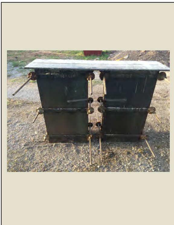
Imatge 5.1.2.15: Motlles de planxa acabats i tapats per protegir el producte desencofrant.
