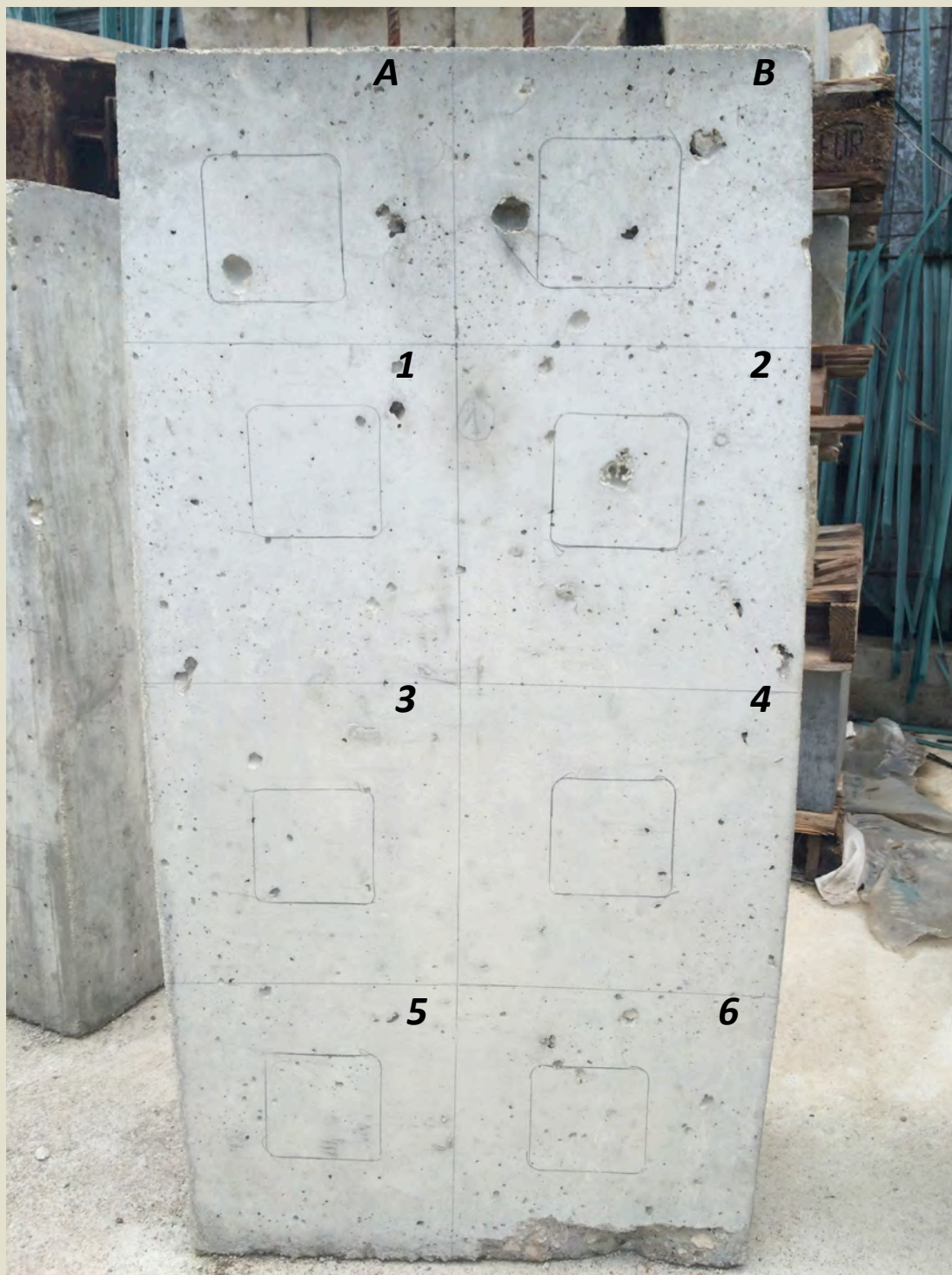
Imatge 5.1.3.4: Visualització general del mètode estadístic de densitat i cobertura. Proveta MF2A2 . Rn: 25mm i amb elements intermitjos.
