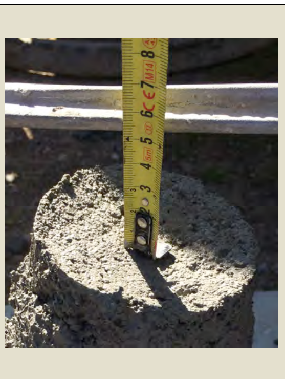
Imatge 4.43: Assentament (2) 5,2cm. Foto: Albert Coromina / Font: Pròpia
