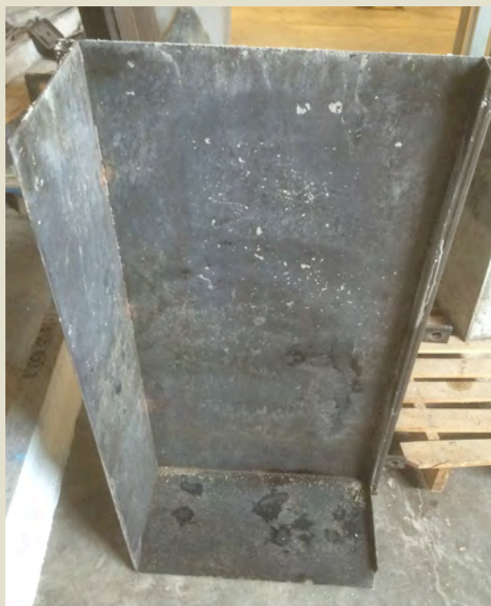
Imatge 3.2.41 : Encofrat de planxa.
