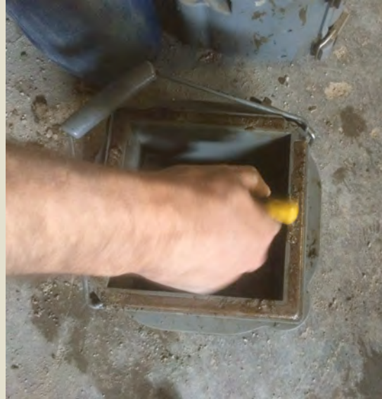
Imatge 3.2.29: Untat de proveta cúbica amb oli desencofrant. Foto: Albert Coromina / Font: Pròpia
