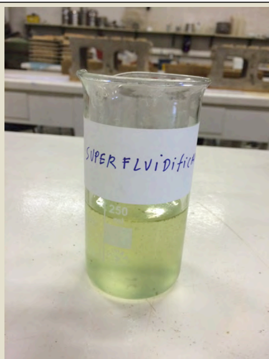
Imatge 3.1.19: Matèria prima. Superfluidificant Glenium ACE 425 Foto: Albert Coromina / Font: Pròpia
