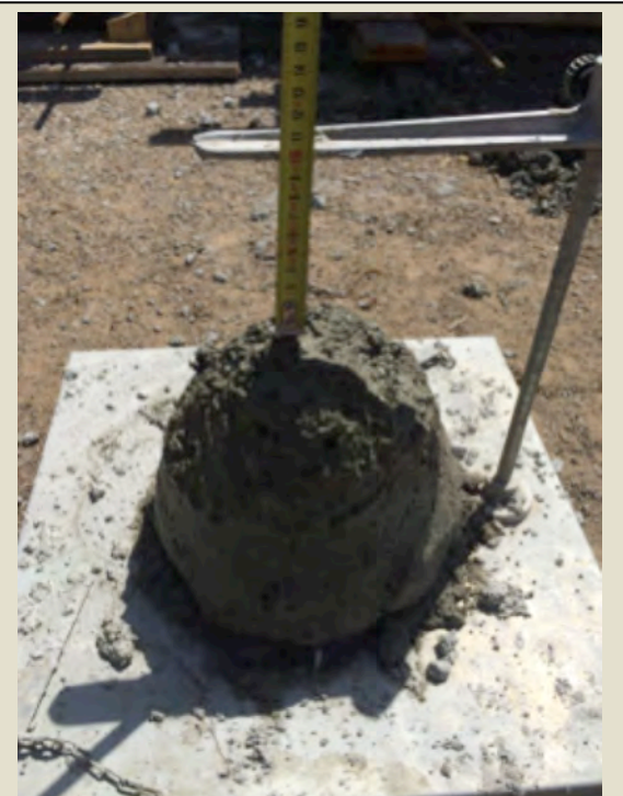
Imatge 5.3.2.9: Assaig (1) con d'Abrams. Assentament de 10 cm. Consistència fluïda.
