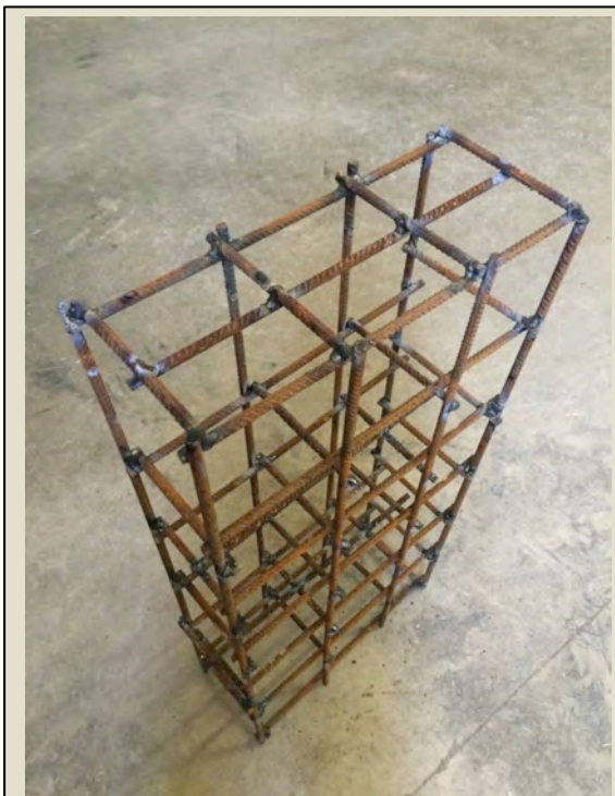
Imatge 5.1.2.3: Armat amb elements intermitjos.
