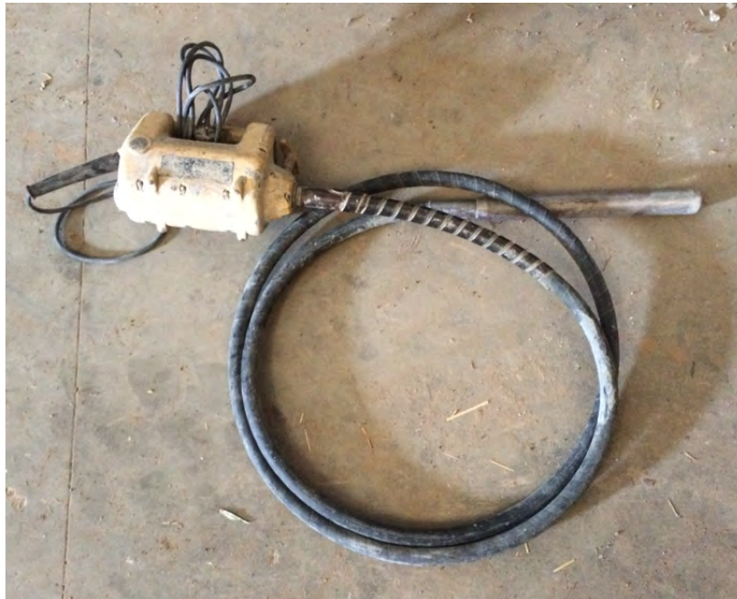
Imatge 5.3.1.1: Vibrador utilitzat Assaig 2.
