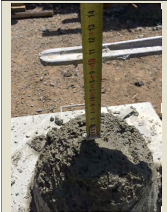
Imatge 5.3.2.8: Assaig (1) con d'Abrams. Assentament de 10 cm. Consistència fluïda.
