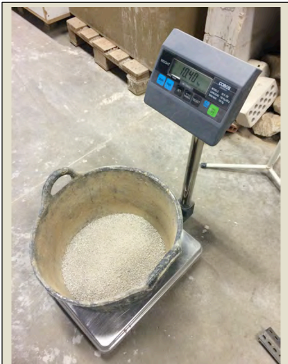
Imatge 3.2.11 : Preparació dosificació per amassada. Pesada sorra 0-4mm.
