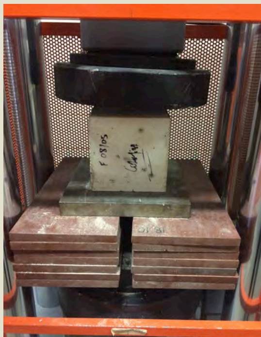
Imatge 5.1.3.7: Proveta col·locada a la premsa.
