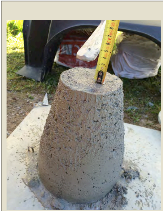
Imatge 4.40: Assaig 1 con d'Abrams segons (UNE-EN 12350-2). Consistència tova (5-10). Foto: Albert Coromina / Font: Pròpia
