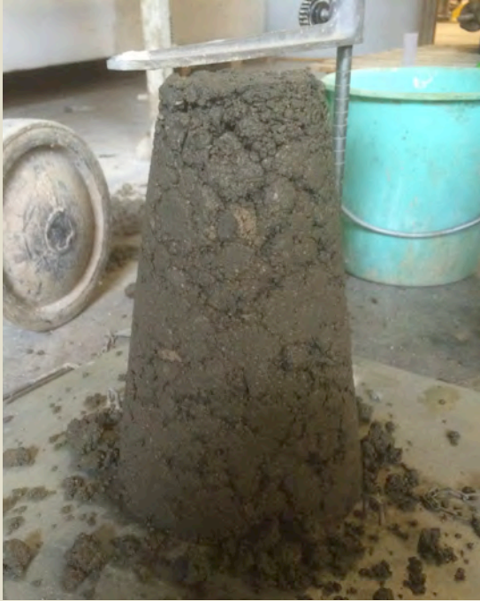
Imatge 3.2.28: Assaig con d'Abrams segons (UNE-EN 12350-2). Consistència seca (0-2). Foto: Albert Coromina / Font: Pròpia
