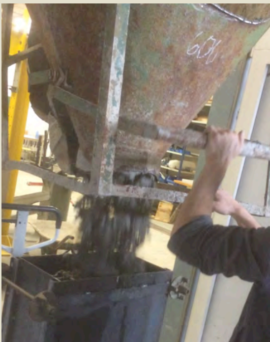
Imatge 3.2.35: Abocat amassada (2) amb cubilot.
