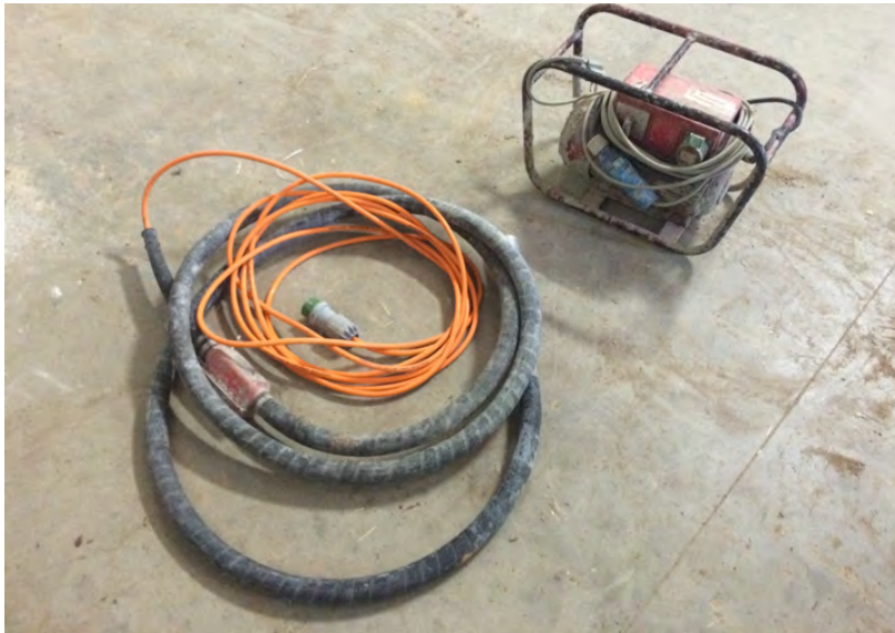
Imatge 5.3.1.3: Vibrador utilitzat Assaig 3.
