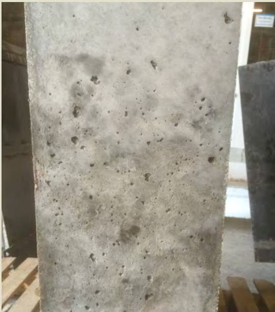
Imatge 3.2.46: Canvi tonalitat coincidint amb el canvi de consistència de cada amassada. Foto: Albert Coromina / Font: Pròpia
