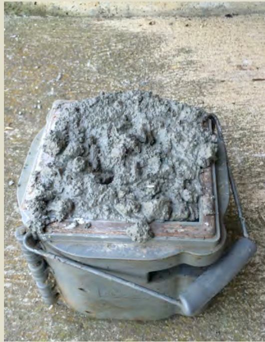
Imatge 4.45: Fabricació de proveta. Foto: Albert Coromina / Font: Pròpia
