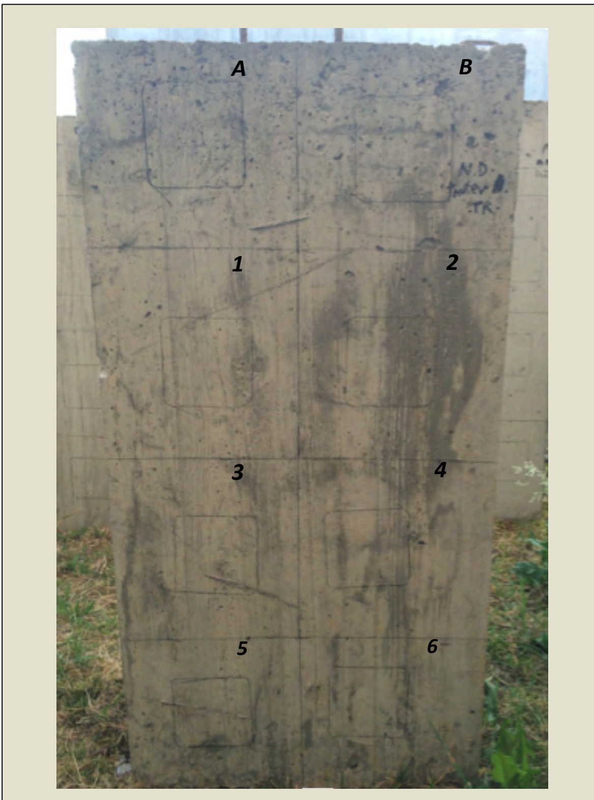
Imatge 5.2.3.4: Visualització general del mètode estadístic de densitat i cobertura aplicat al tauler mixta. (Cara tauler fusta d'abet).
