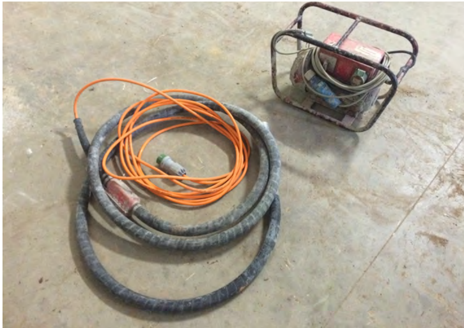
Imatge 5.2.4.3: Vibrador utilitzat Assaig 3.
