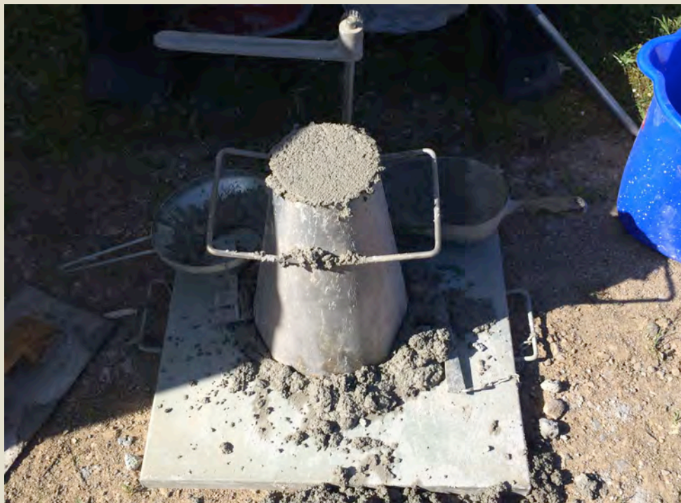
Imatge 5.1.2.19: Assaig con d'Abrams segons (UNE-EN 12350-2). Consistència tova (5-10). Foto: Albert Coromina / Font: Pròpia
