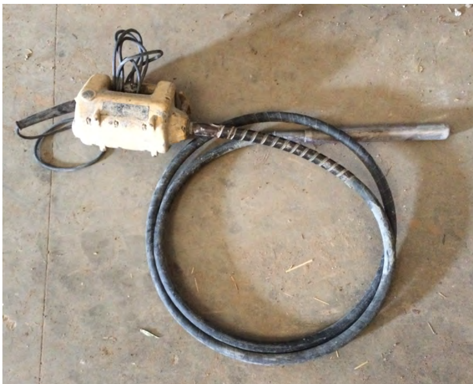
Imatge 5.2.4.1: Vibrador utilitzat Assaig 2.
