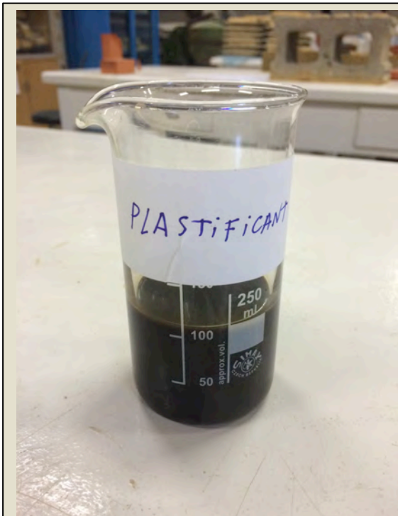
Imatge 3.1.18: Matèria prima. Plastificant BASF-Pozzolith 475 N Foto: Albert Coromina / Font: Pròpia
