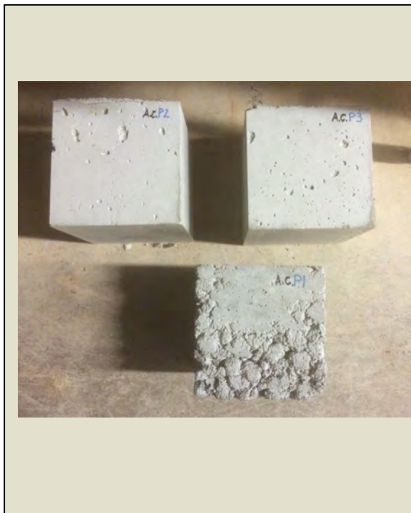
Imatge 3.3.1: Conjunt de provetes de les 3 amassades. De baix cap a dalt i d'esquerra a dreta. (Amassada 1, 2 i 3). Foto: Albert Coromina / Font: Pròpia
