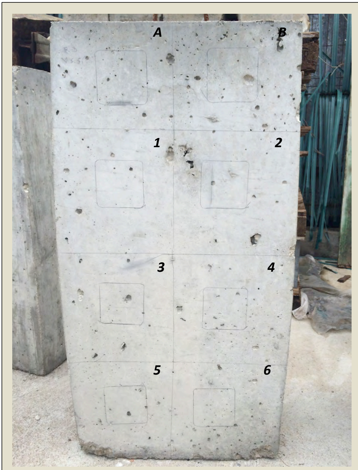
Imatge 5.1.3.5: Visualització general del mètode estadístic de densitat i cobertura. Proveta MF2A2 . Rn: 40mm i amb elements intermitjos.
