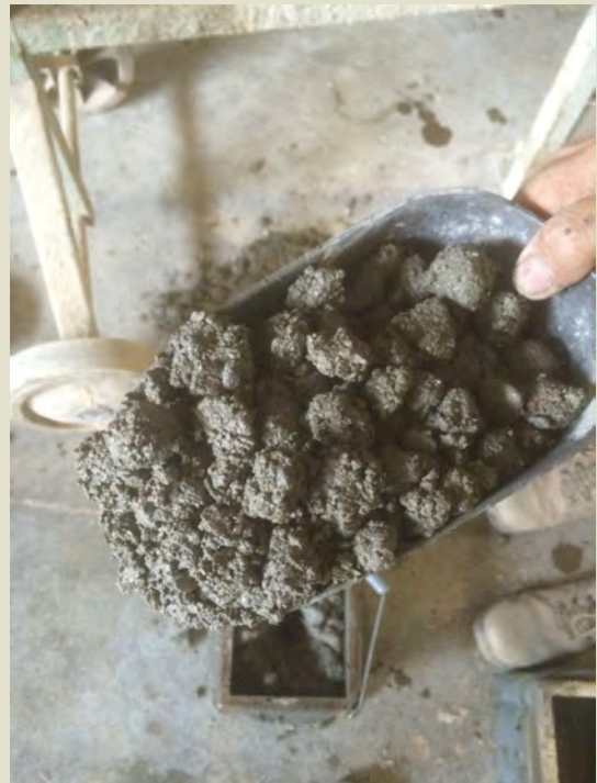
Imatge 3.2.27: Amassada (1) poc homogènia.
