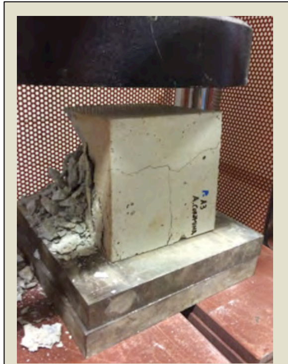
Imatge 4.63: Trencament de la proveta.
