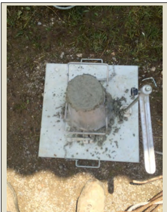
Imatge 5.2.2.16: Assaig (1) con d'Abrams segons (UNE-EN 12350-2). Consistència tova (5-10).
