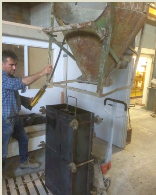
Imatge 3.2.31: Abocat amassada (1) amb cubilot. Foto: Albert Coromina / Font: Pròpia
