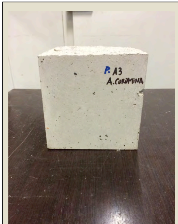
Imatge 4.48: Identificació de la proveta i col·locació a la cambra humida.
