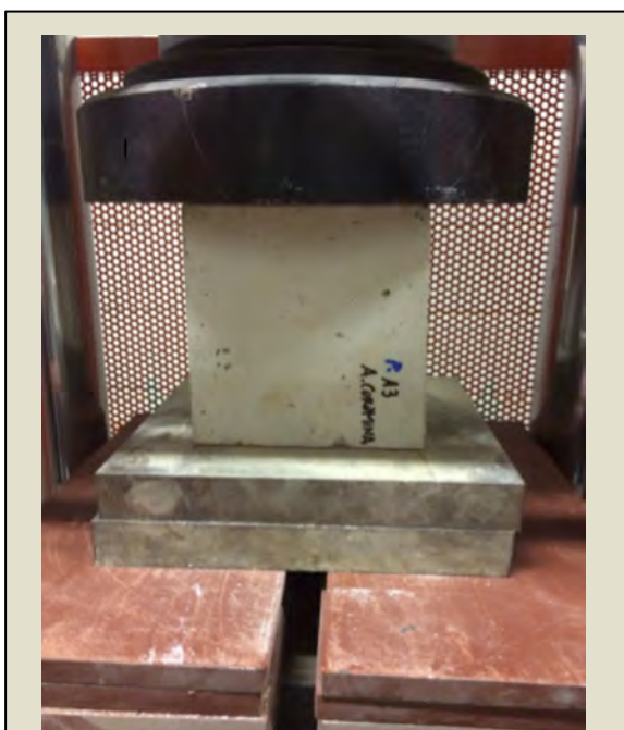
Imatge 4.60: Provena col·locada a la premsa. Foto: Albert Coromina / Font: Pròpia
