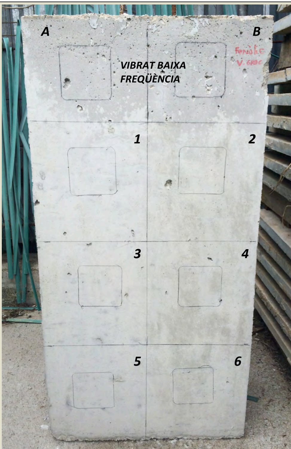
Imatge 5.3.3.3: Visualització general del mètode estadístic de densitat i cobertura. Provena MF2A4 (cara A). Vibrat baixa freqüència.
