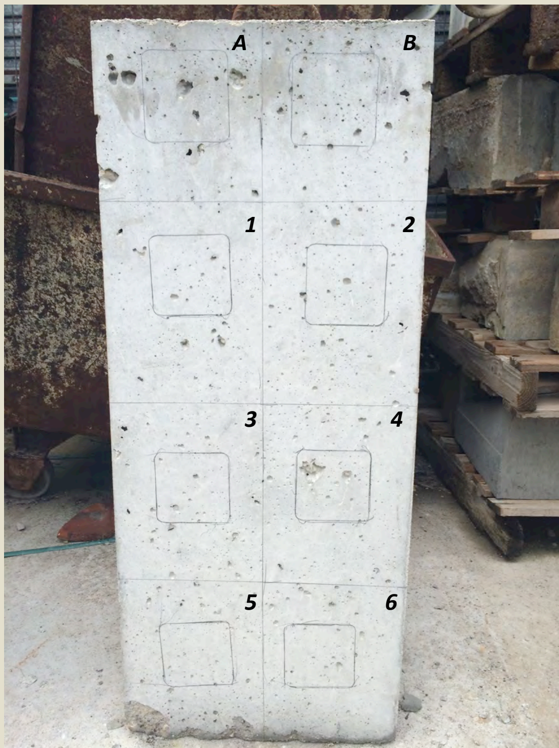
Imatge 5.1.3.1: Visualització general del mètode estadístic de densitat i cobertura. Proveta MF1A2 . Rn: 25mm i sense elements intermitjos.
