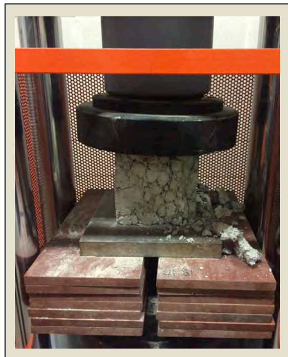
Imatge 3.3.2: Trencament de la probeta AC.P1. Amassada 1. Foto: Albert Coromina / Font: Pròpia
