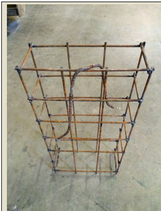
Imatge 5.1.2.4: Armat sense elements intermitjos.
