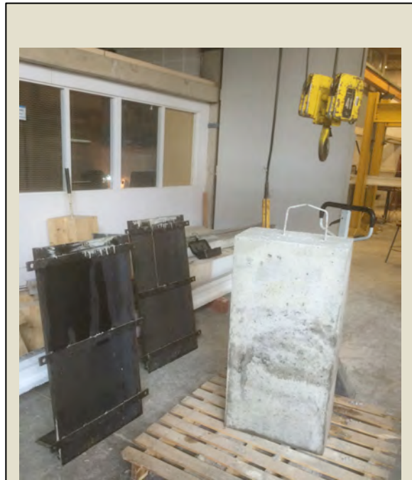
Imatge 3.2.40: Desencofrat (5 dies després).
