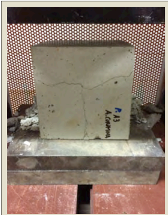
Imatge 4.62: Trencament de la proveta.
