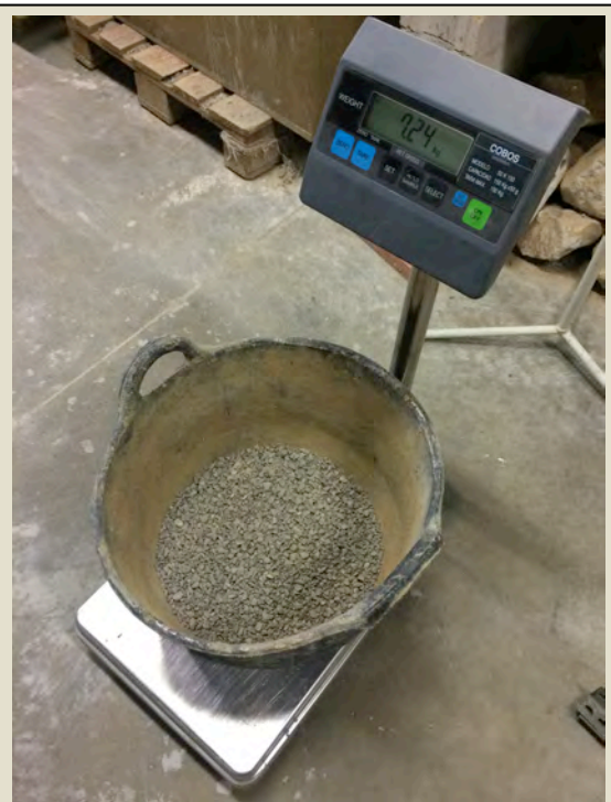
Imatge 3.2.12: Preparació dosificació per amassada. Pesada grava 4-10mm.
