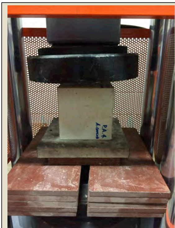
Imatge 5.3.3.6: Provetta col·locada a la premsa.
