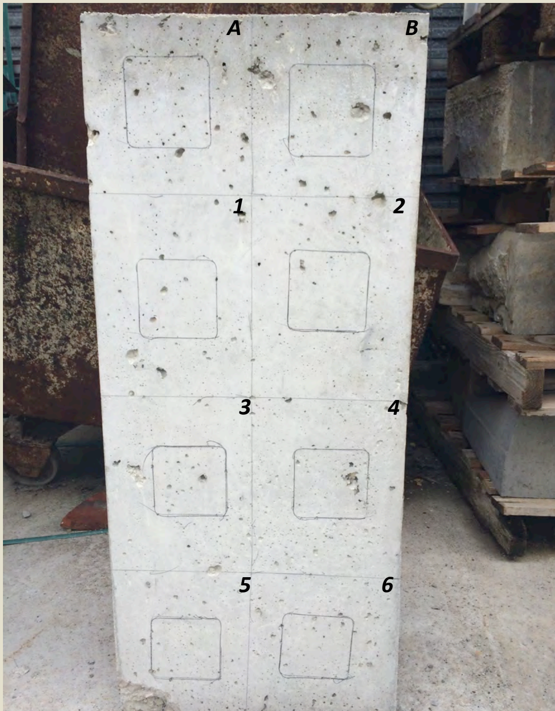
Imatge 5.1.3.2: Visualització general del mètode estadístic de densitat i cobertura. Proveta MF1A2 . Rn: 40 mm i sense elements intermitjos.
